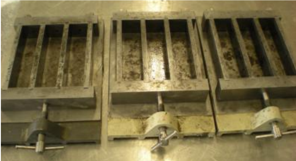
Abbildung 29: 3 Schalungen für 3 Probekörper mit den Abmessungen 40x40x160 mm
