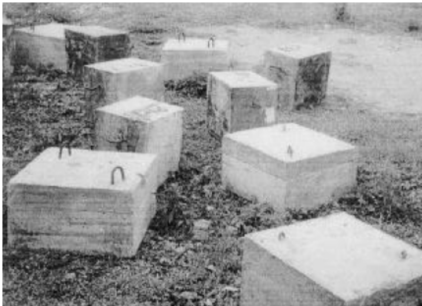
Abbildung 20: Betonprobewürfel für das Beschießen mit Hochgeschwindigkeitsprojektilen [11]
