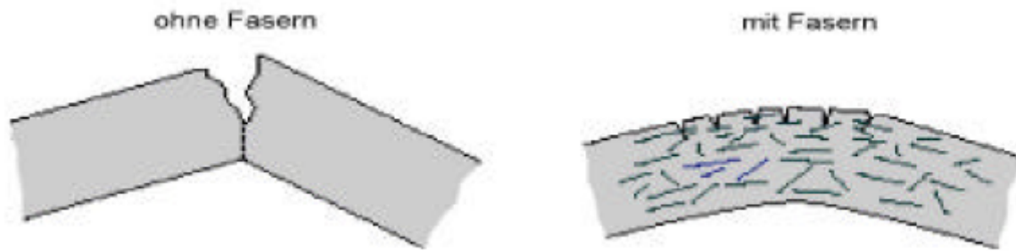
Abbildung 9: Rissbildung im Beton mit und ohne Faser [11]
