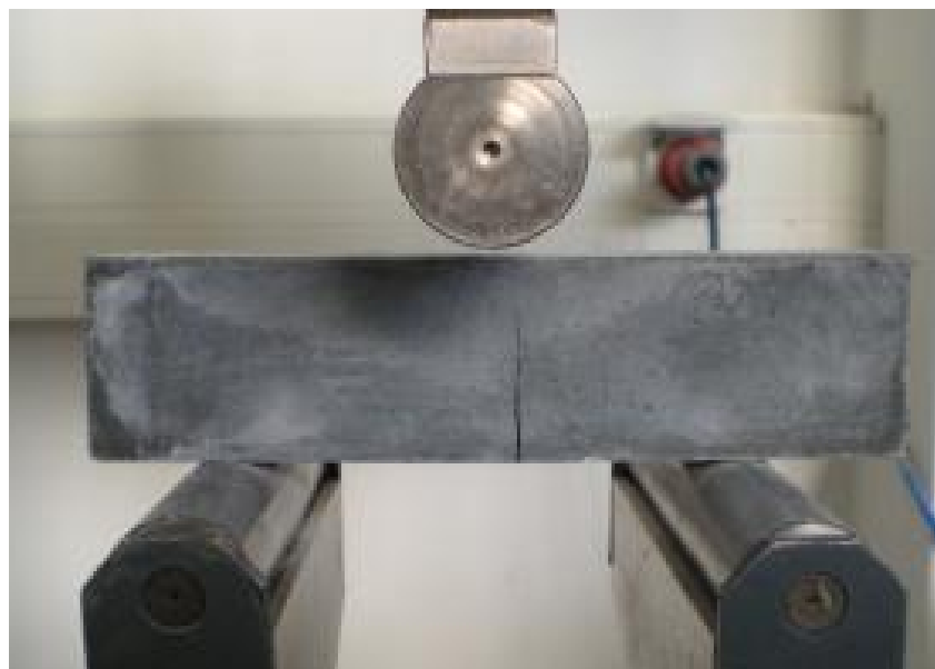
Abbildung 129: Stahlfaserprobe nach dem Biegezugversuch
