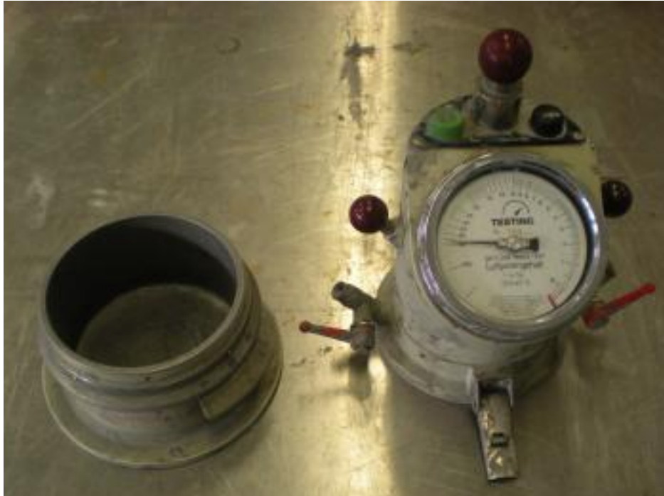
Abbildung 26: Luftporentopf und Verschlussdeckel zur Bestimmung des Luftgehalts im Frischbeton
