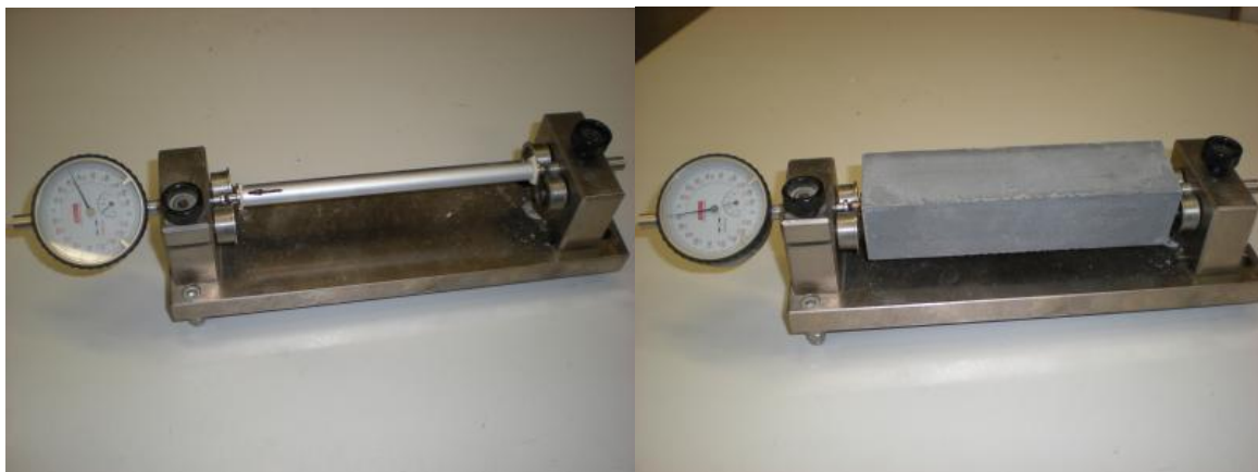
Abbildung 38: linkes Bild: Messvorrichtung mit Referenzstab, rechtes Bild: Messvorrichtung mit Prüfkörper
