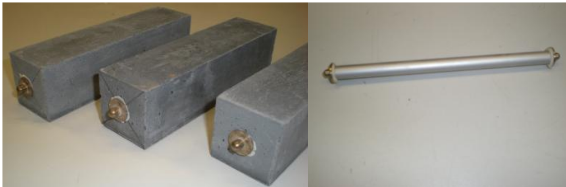
Abbildung 37: linkes Bild: Prüfkörper mit Messzapfen, rechtes Bild: Referenzstab
