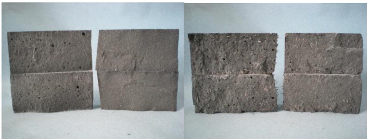
Abbildung 143: Vier Spaltzugbruchhälften, linkes Bild: Basaltfaserprobe ohne/mit Vakuumbehandlung, rechtes Bild: Stahlfaserprobe ohne und mit Vakuumbehandlung
