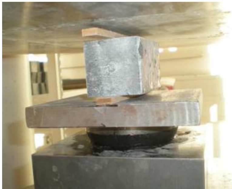
Abbildung 34: Spaltzugversuch nach ÖNORM EN 12390-6
