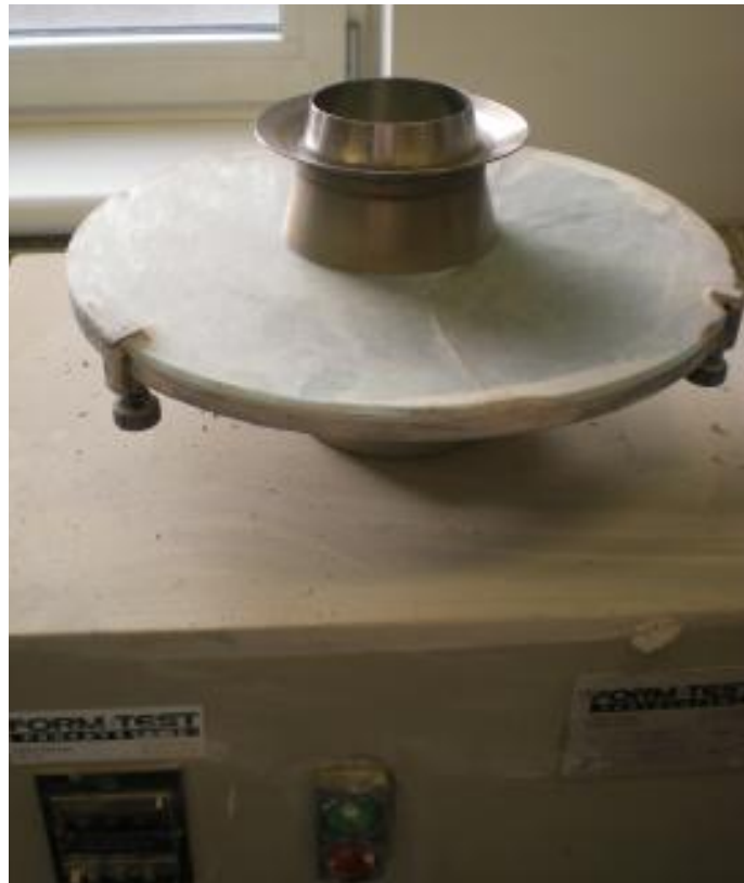
Abbildung 27: Ausbreittisch mit Setztrichter zur Ermittlung des Ausbreitmaßes
