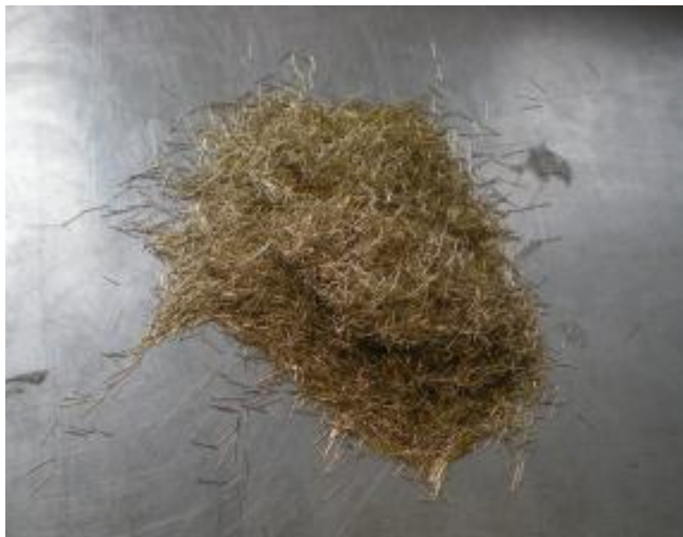
Abbildung 107: Stahlfaser 6 mm und 0,175 mm Durchmesser
