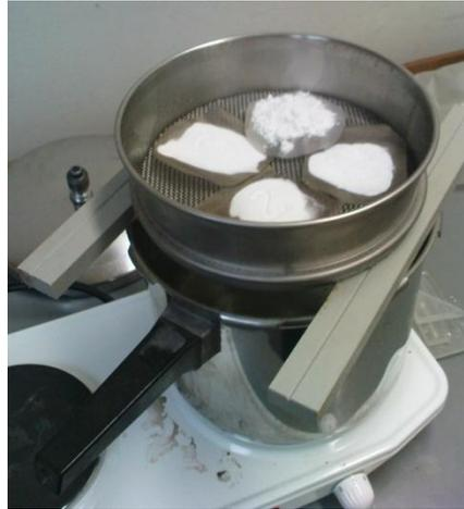
Abbildung 4.1-3: Hydratation mit Wasserdampf
