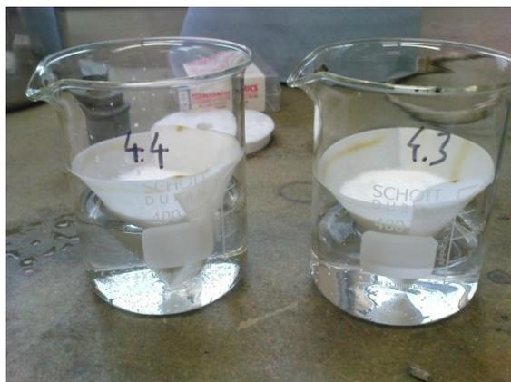
Abbildung 4.1-4: Versuchsaufbau Hydratation mit Wasser in der Flüssigphase
