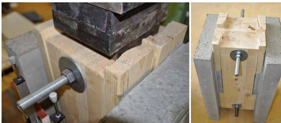
Abb. 5.11: Scherversagen in den HBV-Abscherversuchen [2]
