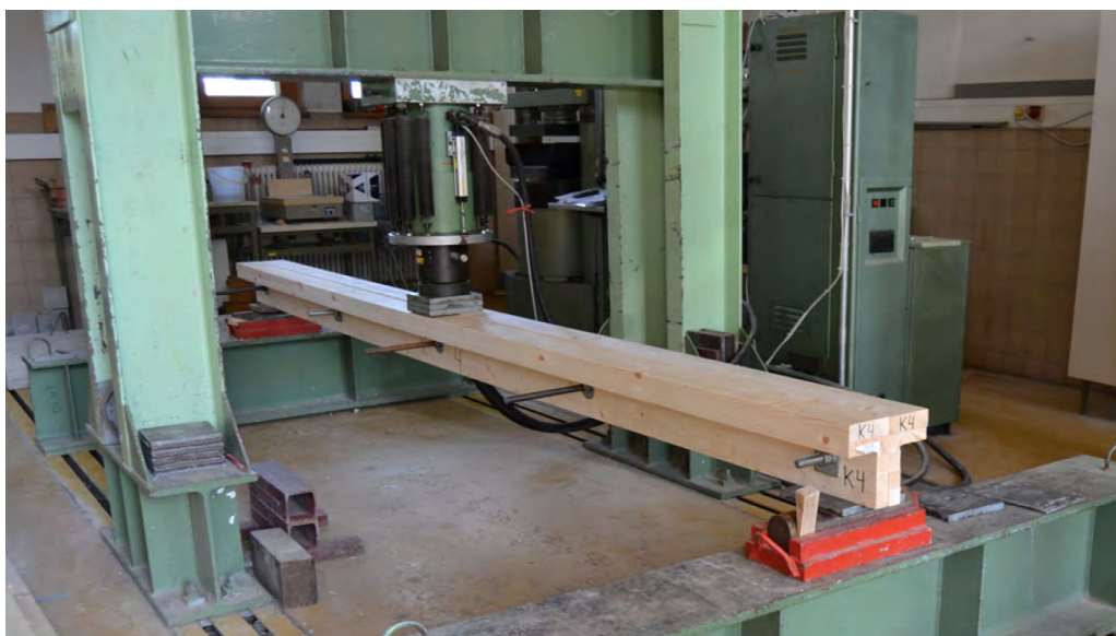
Abb. 5.6: Drei-Punkt-Biegeversuch an der hydraulischen Presse zur Ermittlung des E-Moduls, schön zu erkennen sind die fünf Gewindestangen [2]
