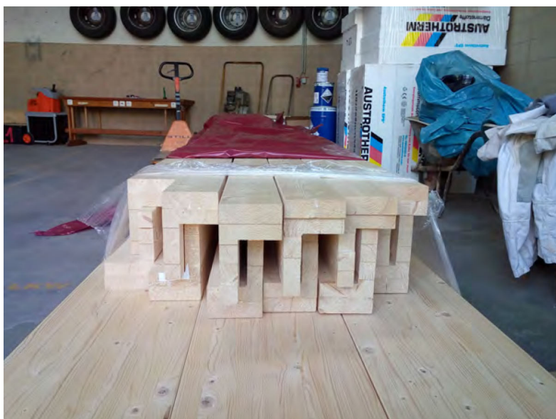
Abb. 5.5: Gelieferte L-Profile aus Brettschichtholz mit horizontalen Klebefugen [2]
