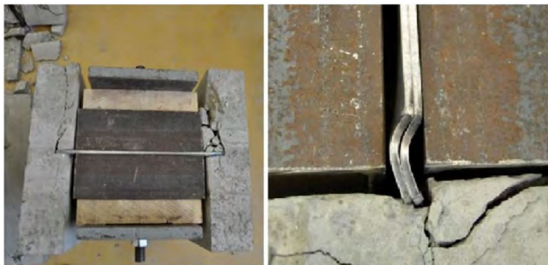
Abb. 5.12: Scherversagen in den Stahl-Beton-Verbund Abscherversuchen [2]
