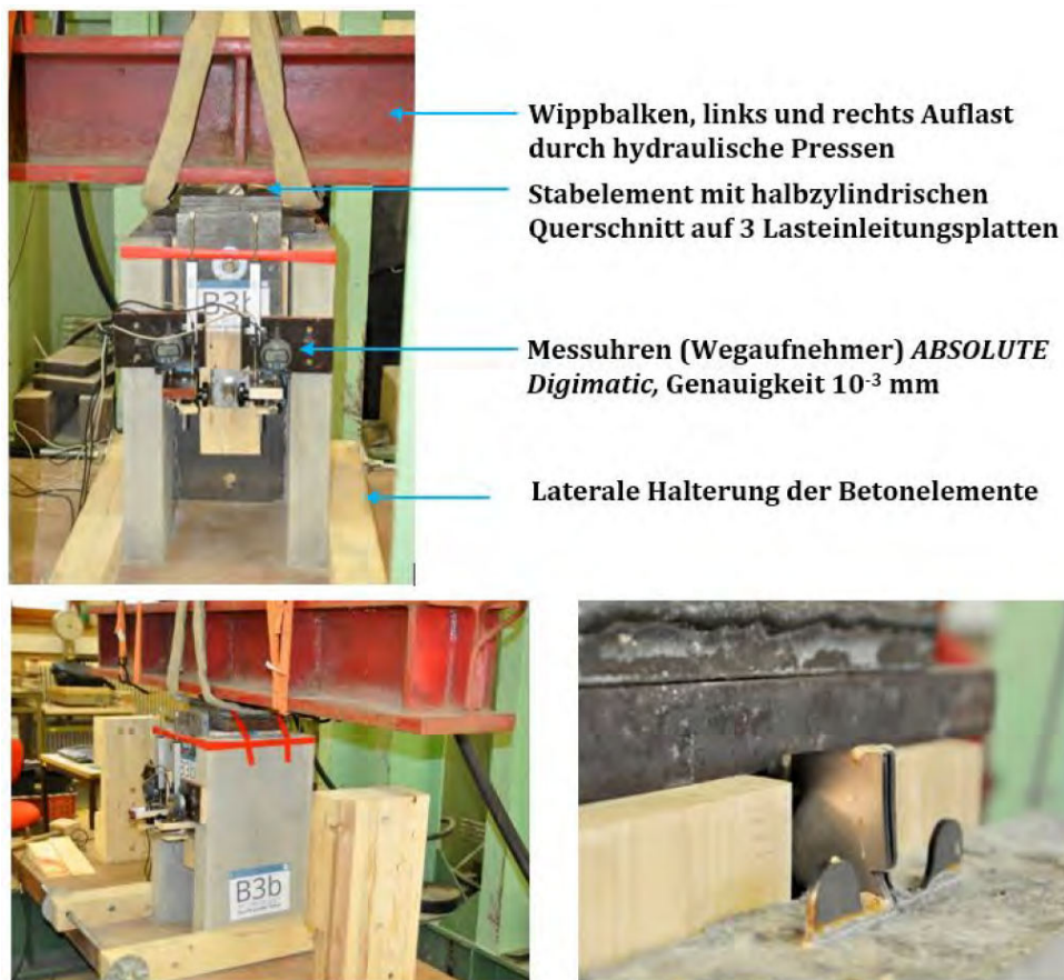
Abb. 5.10: Aufbau der Stahl-Beton-Abscherversuche [2]
