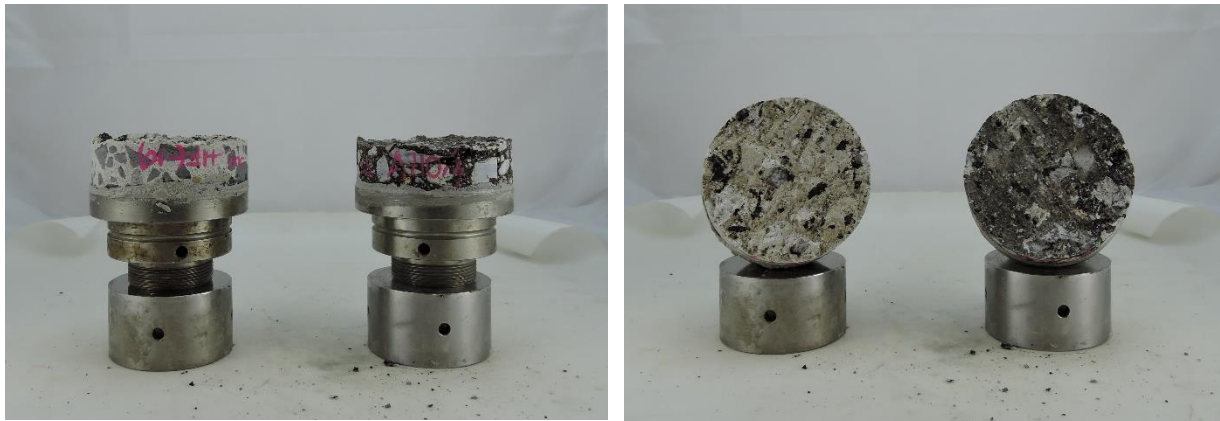
Abb. 23: Probekörper nach Versuchsdurchführung bei -10^{\circ}\text{C}
