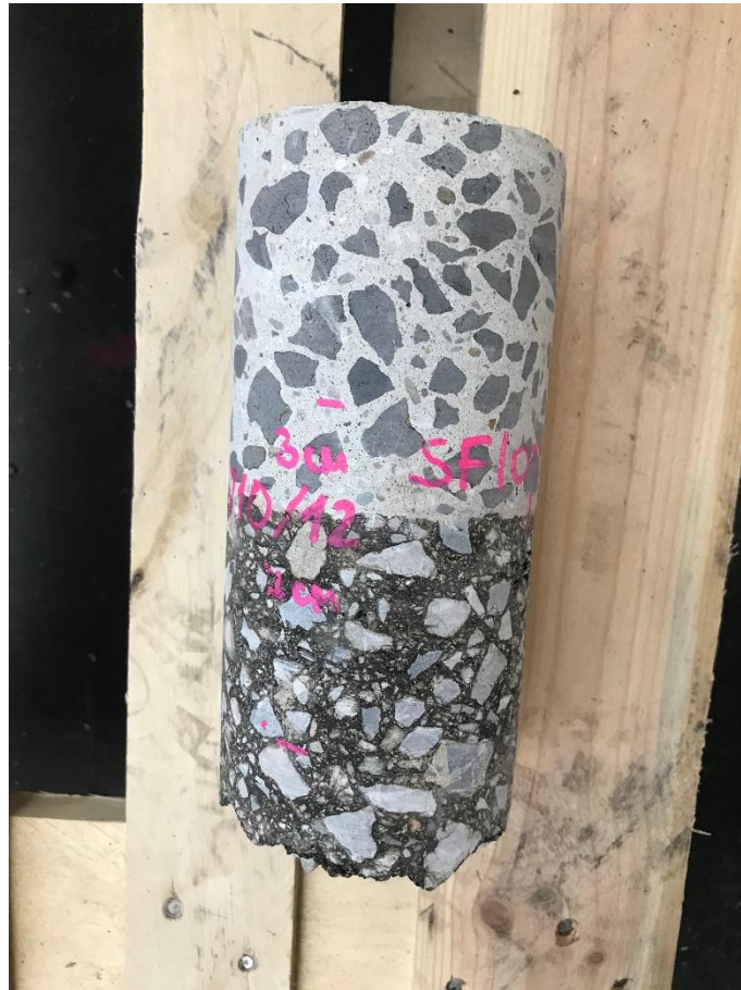
Abb. 34: Bohrkernprobe für die Schubfestigkeitsprüfung
