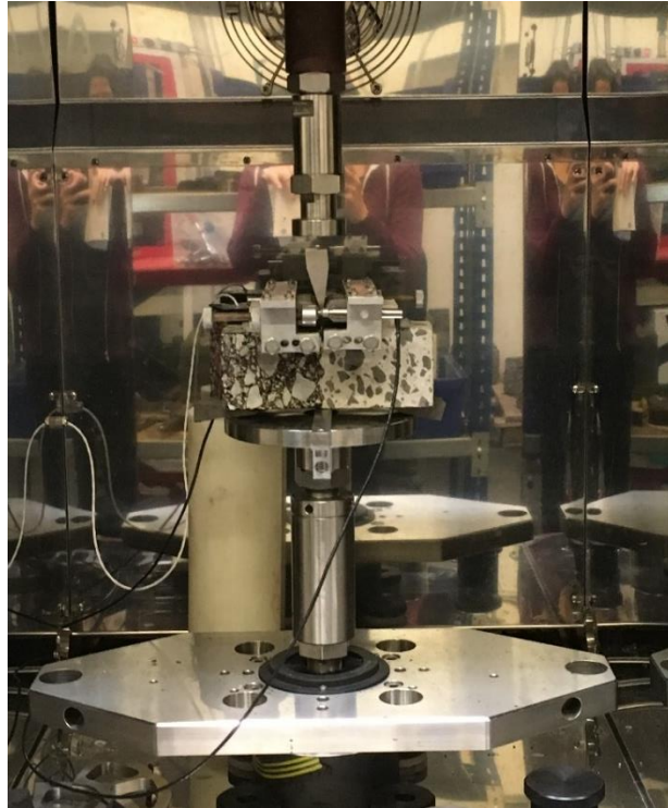
Abb. 49: Probekörper in der Prüfvorrichtung vor Beginn der Keilspaltfestigkeitsprüfung
