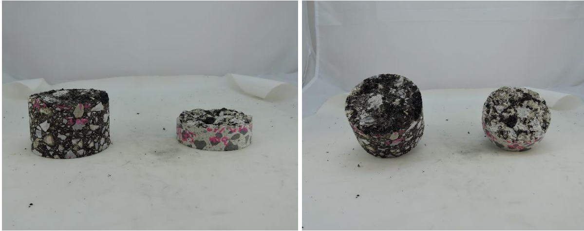
Abb. 36: Probekörper nach Versuchsdurchführung bei 0°C
