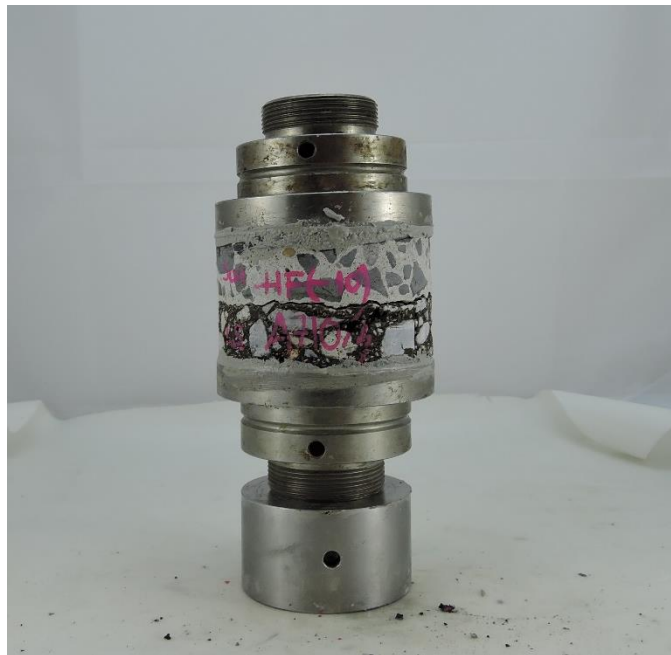
Abb. 22: Probekörper mit Stempel nach Versuchsdurchführung bei -10^{\circ}\text{C}
