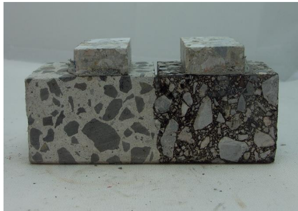
Abb. 52: Probekörper vor Durchführung der Keilspaltfestigkeitsprüfung bei -10°C
