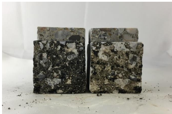
Abb. 53: Probekörper nach Durchführung der Keilspaltfestigkeitsprüfung bei -10°C
