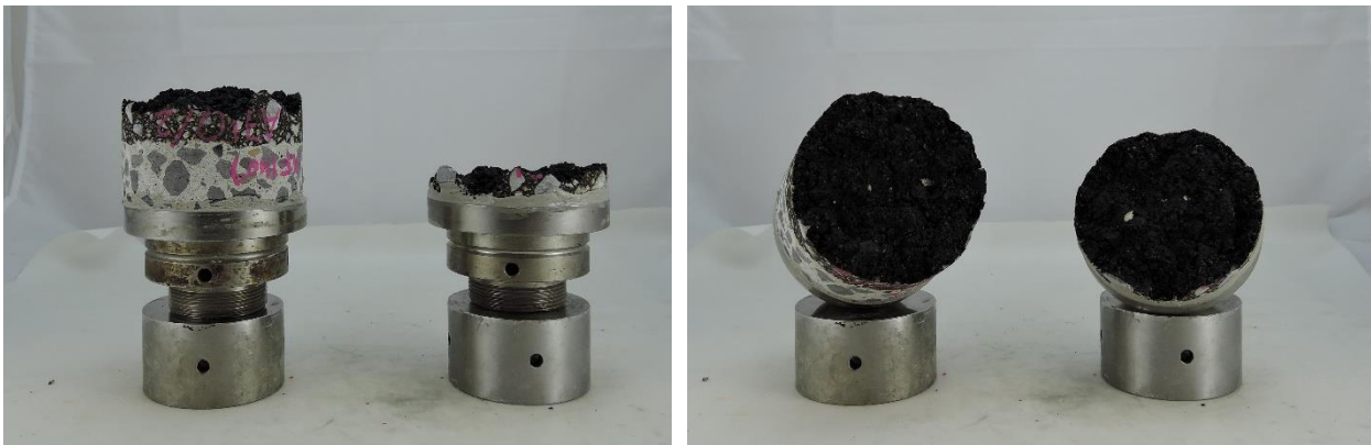
Abb. 28: Fehlerhafter Probekörper bei +40 Grad (Probekörper 2)
