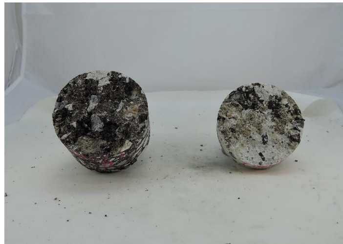
Abb. 39: seitlicher Abbruch der Betonprüffläche beim Probekörpers 1 (+20 Grad)
