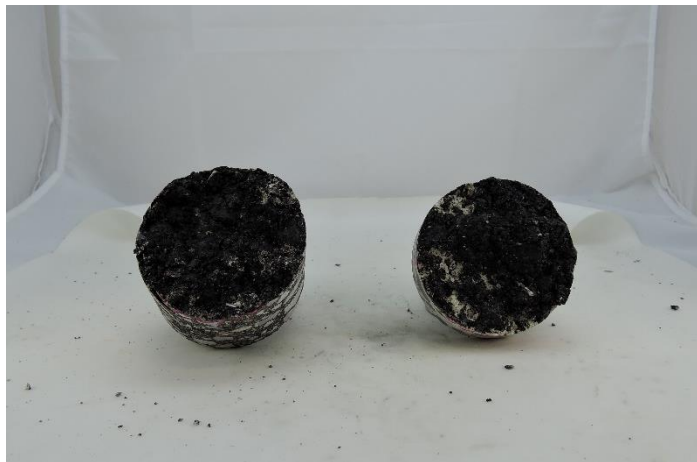
Abb. 41: Fehlerhafter Probekörper bei +40 Grad (Probekörper 1)
