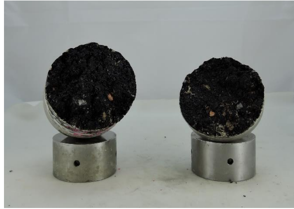
Abb. 27: Versagensfoto des 1. Probekörpers (+20 Grad)
