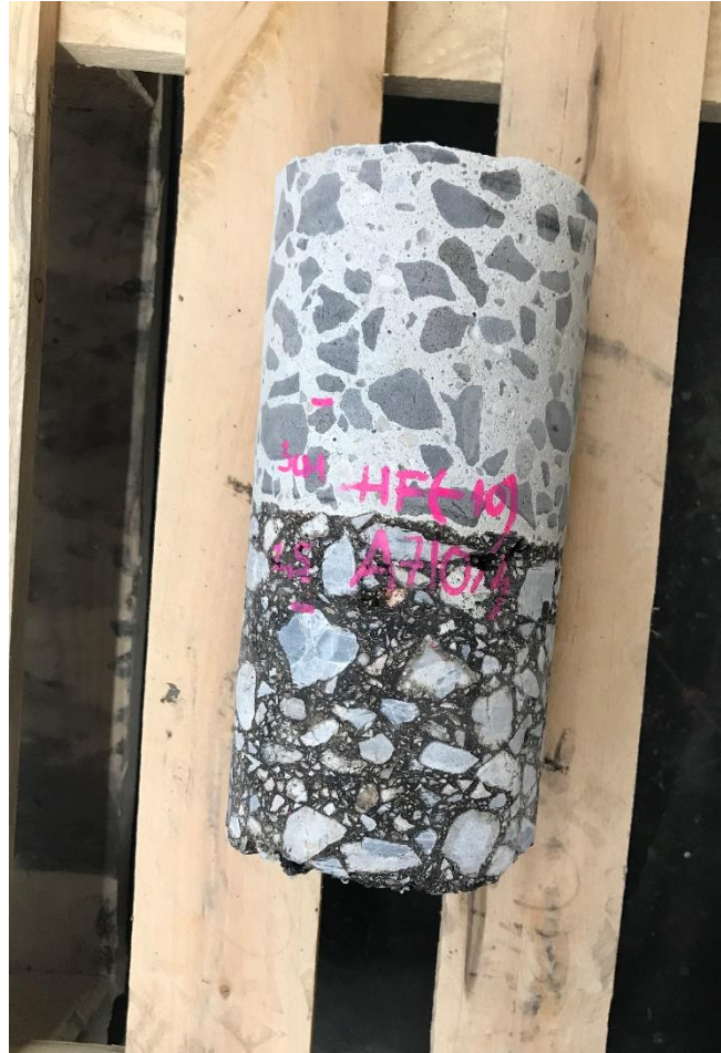
Abb. 21: Bohrkernprobe für die Haftzugfestigkeitsprüfung
