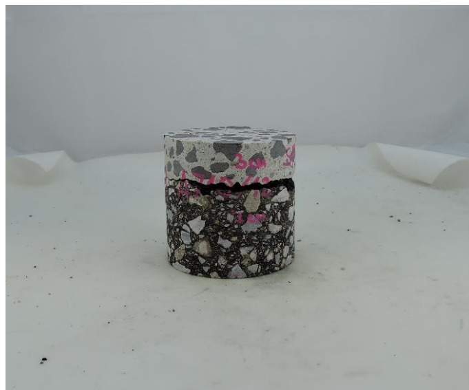
Abb. 35: Probekörper nach Versuchsdurchführung bei 0°C
