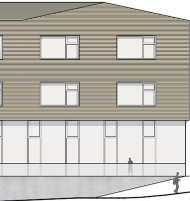
Außenwände und Dach mit Lärchenholzschalung verkleidet
