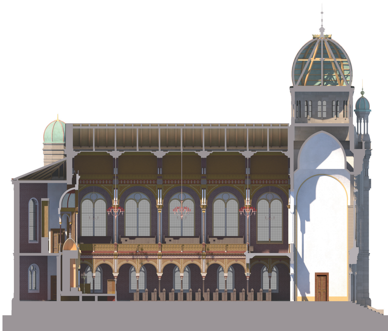
Abb. 60: Schnitt durch das Gebäude in Längsrichtung.
