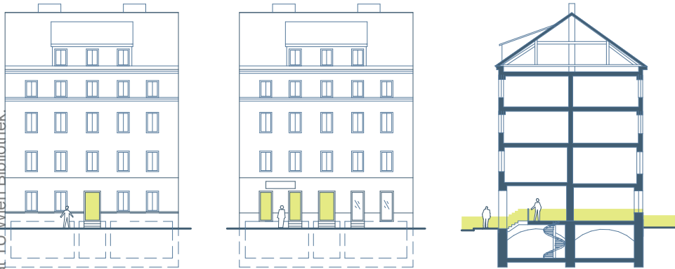
Abb. 39: Ansicht und Schnitt eines Gründerzeithauses mit nachträglicher Veränderung der Permeabilität der Fassade
