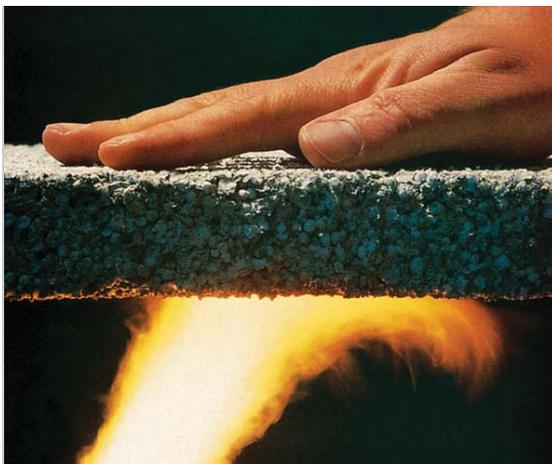
Abb.25 Brandwiderstandsfähigkeit des Betons
