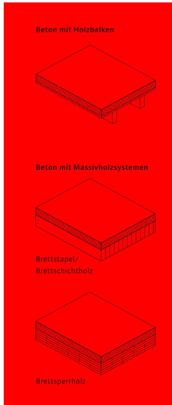
**Abb.29** Varianten von HBV-Decken
