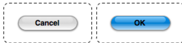
Abbildung 6.1 – Iceberg Tips in Form zweier Buttons. Die strichlierte Linie stellt die unsichtbare Grenze des Touch-Objekts dar, adaptiert nach [Saf09, Seite 43].
