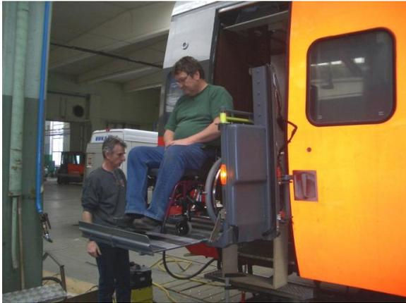
**Abb. 35:** Elektromechanische fahrzeuggebundene Hublifte von NSB
