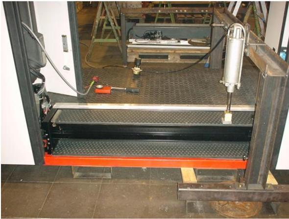
**Abb. 48:** Klapptritt hochgeklappt für Bahnsteighöhe 760mm über SO
