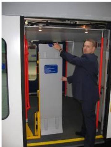
**Abb. 20:** Die Funktionsweise manueller fahrzeuggebundener Rampen Schritt 1
