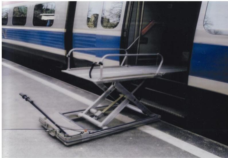
**Abb. 34:** Ein fahrzeuggebunder halbautomatischer Hublift von Laila Lindholm Berkahn
