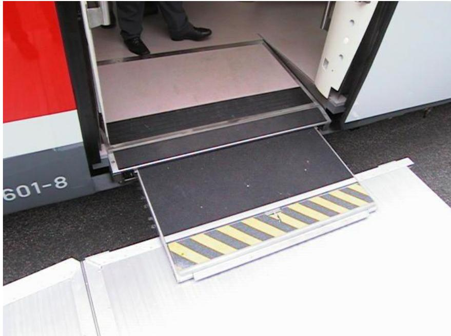
**Abb. 23:** Elektromechanische fahrzeuggebundene Rampe bei der Deutsche Bahn AG
