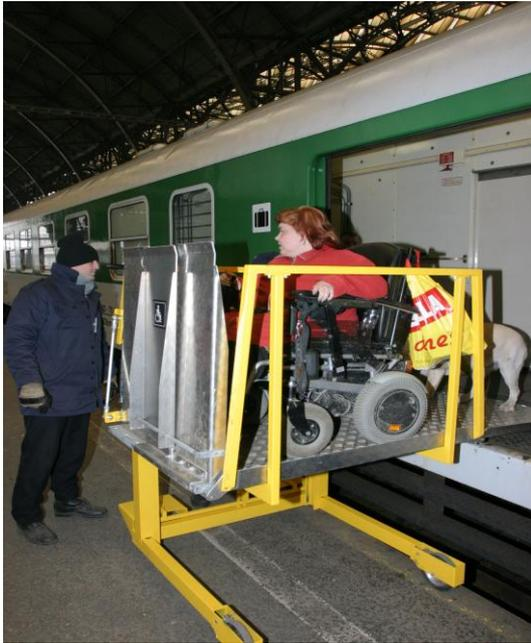
**Abb. 30:** Einstiegshilfe eines Kunden mit einem Hublift bei einem hochflurigen Fahrzeug
