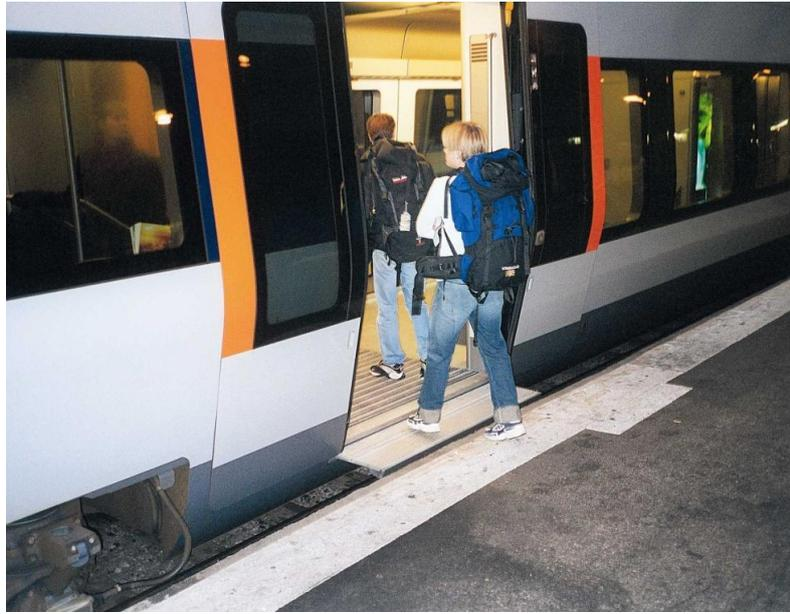
**Abb. 56:** Elektromechanische fahrzeuggebundene Spaltüberbrückung beim Regionalzug Öresundstag der Laila Lindholm Berkhahn Stockholm
