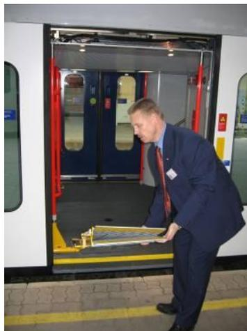
**Abb. 21:** Die Funktionsweise manueller fahrzeuggebundener Rampen Schritt 2
