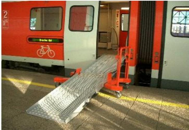
Abb. 26: Rollstuhlrampe – Modell Görlitz (manuelle bahnsteigseitige Rampen)
