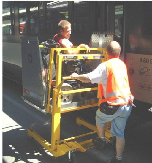
**Abb. 29:** Manuelle bahnsteigseitige Hublifte (Miro-Lift Typ MA 12, Fussantrieb)
