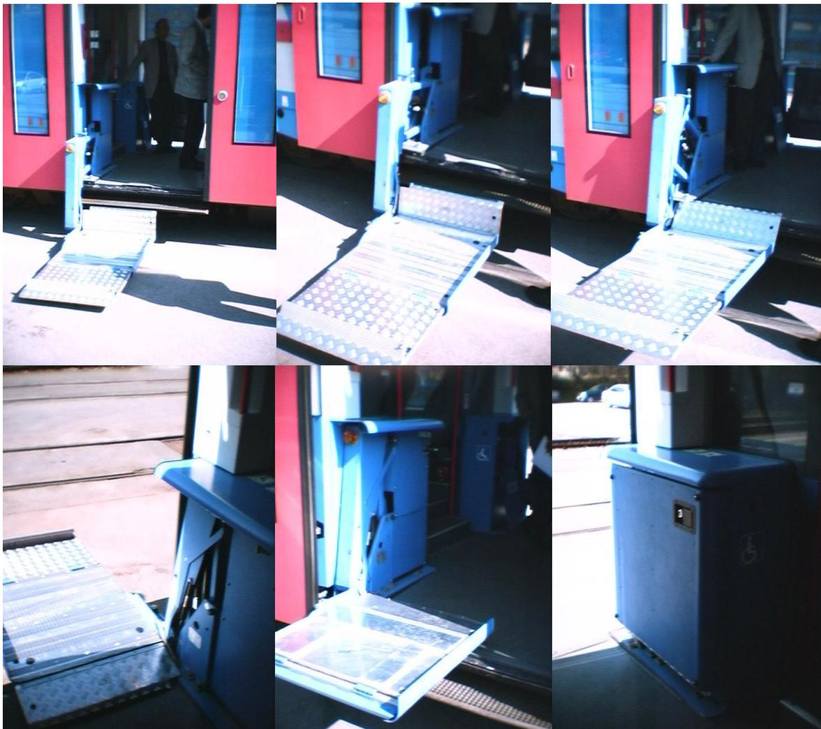
**Abb. 37:** Einsatz des elektromechanischen fahrzeuggebundenen Hubliftes der Deutsche Bahn AG in 6 Phasen
