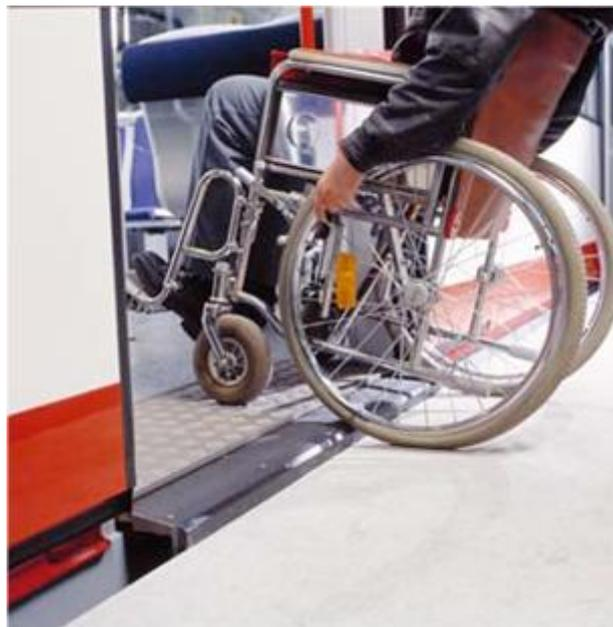
**Abb. (55):** Lösung: Spaltüberbrückung
