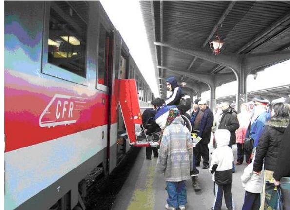
**Abb. 36:** Elektromechanische fahrzeuggebundene Hublifte von CRF
