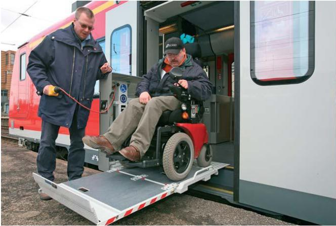
**Abb. 32:** Ein halbautomatischer fahrzeuggebundener Hublift von MBB Trainlift TR
