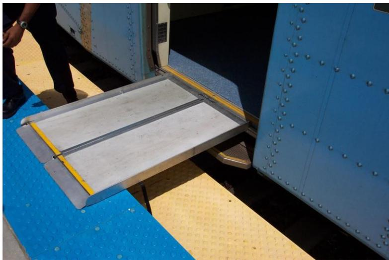
**Abb. 60:** Manuelle bahnsteigseitige Spaltüberbrückungen von RTA
