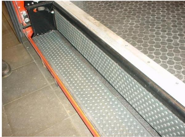
**Abb. 49:** Klapptritt runtergeklappt für Bahnsteighöhe 550 und 380mm über SO
