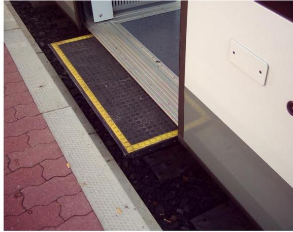
**Abb. 44:** Schiebetritt bei der Deutschen Bahn AG
