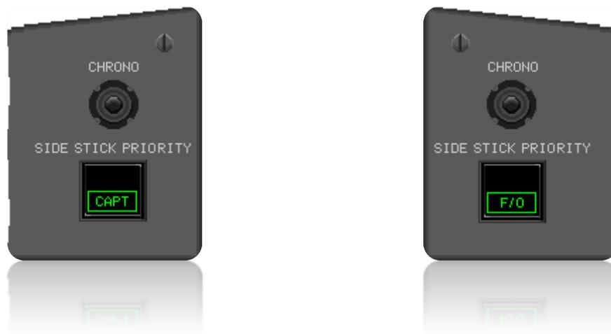
Abbildung 39: Anzeige für einen „Dual Input“. Im Glareshield blinken beide Lämpchen der Side Stick Priority Anzeige. Eine synthetische Stimme warnt zusätzlich mit den Worten „DUAL INPUT“.
