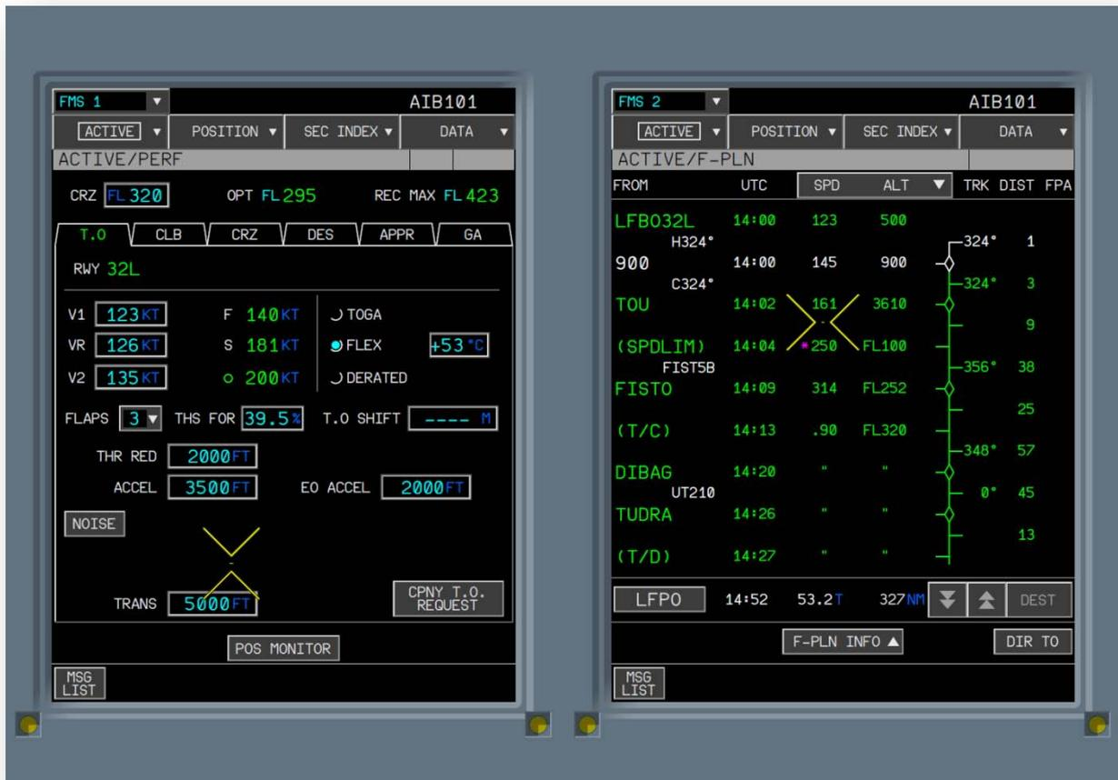
Abbildung 30: Multi Functional Display (MFD) des Airbus A380. In diesem Beispiel sind links die wichtigsten Performance Parameter für den Start und rechts der aktive Flugplan für einen Flug von Toulouse/Blagnac (LFBO) nach Paris/Orly (LFPO) dargestellt. (Quelle: Airbus Industrie)
