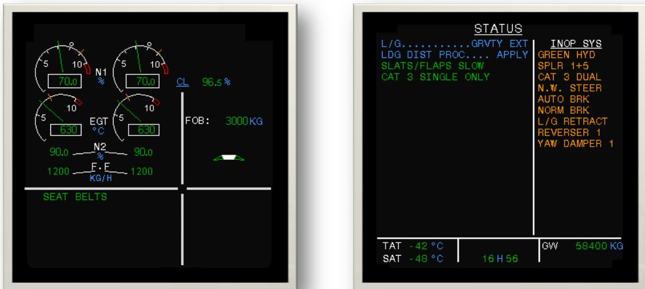
Abbildung 15: Fehler im Hydrauliksystem Schritt 5: Durch erneuten Druck auf den Clear Button erscheint auf dem Systemdisplay die Status Seite (STATUS). (Quelle: Lufthansa Flight Training GmbH)
