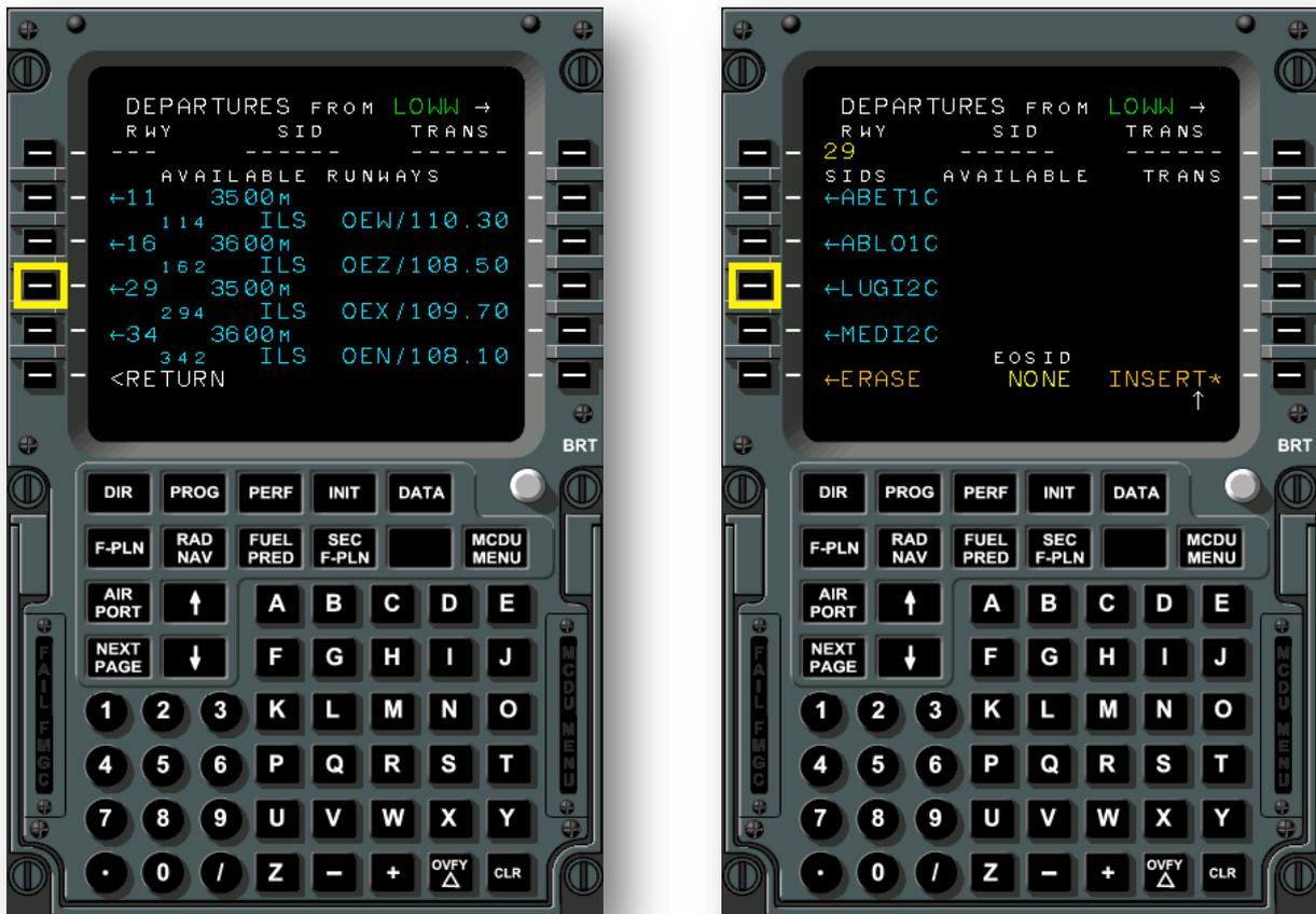
Abbildung 21: FMGS – Eingabe der Flugstrecke (Schritte 5 und 6) – Schritt 5 (links): Nach Druck auf den Schalter neben DEPARTURE erscheinen die Startbahnrichtungen zur Auswahl. Ein Druck auf den Schalter neben 29 transferiert diese Zahl in die erste Reihe. Schritt 6 (rechts): Analog wird das benötigte Abflugverfahren LUGI2C (Standard Instrument Departure, SID) ausgewählt und in die erste Reihe übernommen. (Quelle: CBT Honeywell International Inc., Deutsche Lufthansa AG)
