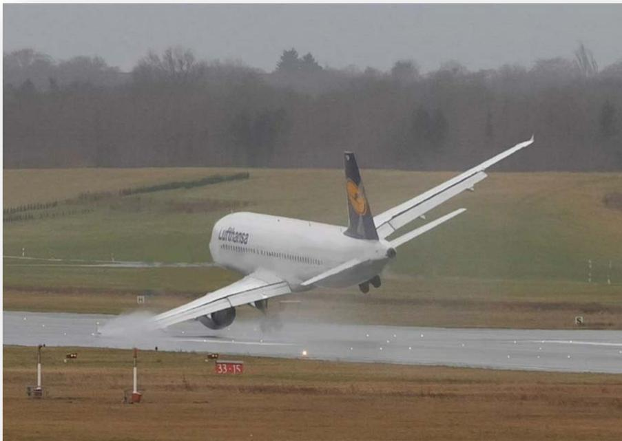
Abbildung 49: Bodenberührung der linken Tragfläche des Airbus A320-211 in Hamburg. (Quelle: Lars Tretau)
