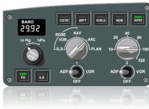
Abbildung 23: EFIS Control Panel – Steuerungseinheit für das Primärflug- und Navigationsdisplay.
