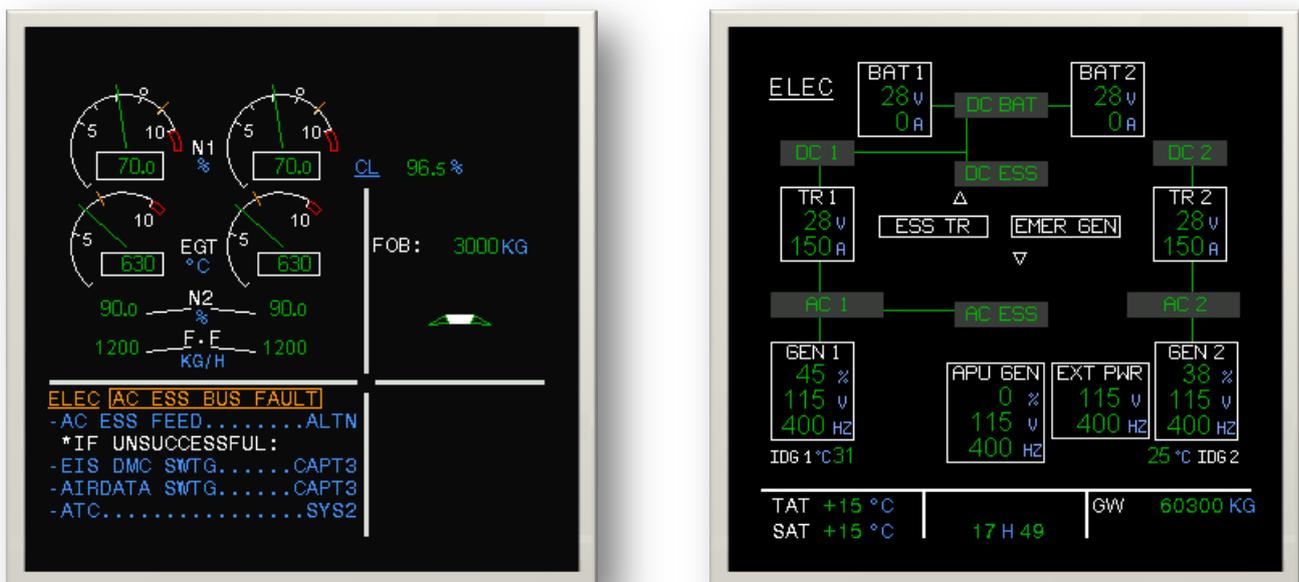
Abbildung 48: Engine/Warning- und Synoptic Display der Elektronik. Links ist jener Teil der Checkliste dargestellt, mit dem – laut Auskunft der Piloten – die Stromzufuhr wieder hergestellt werden konnte. Rechts ist das Synoptic Display der Stromversorgung abgebildet. (Quelle: Luft-hansa Flight Training GmbH)
