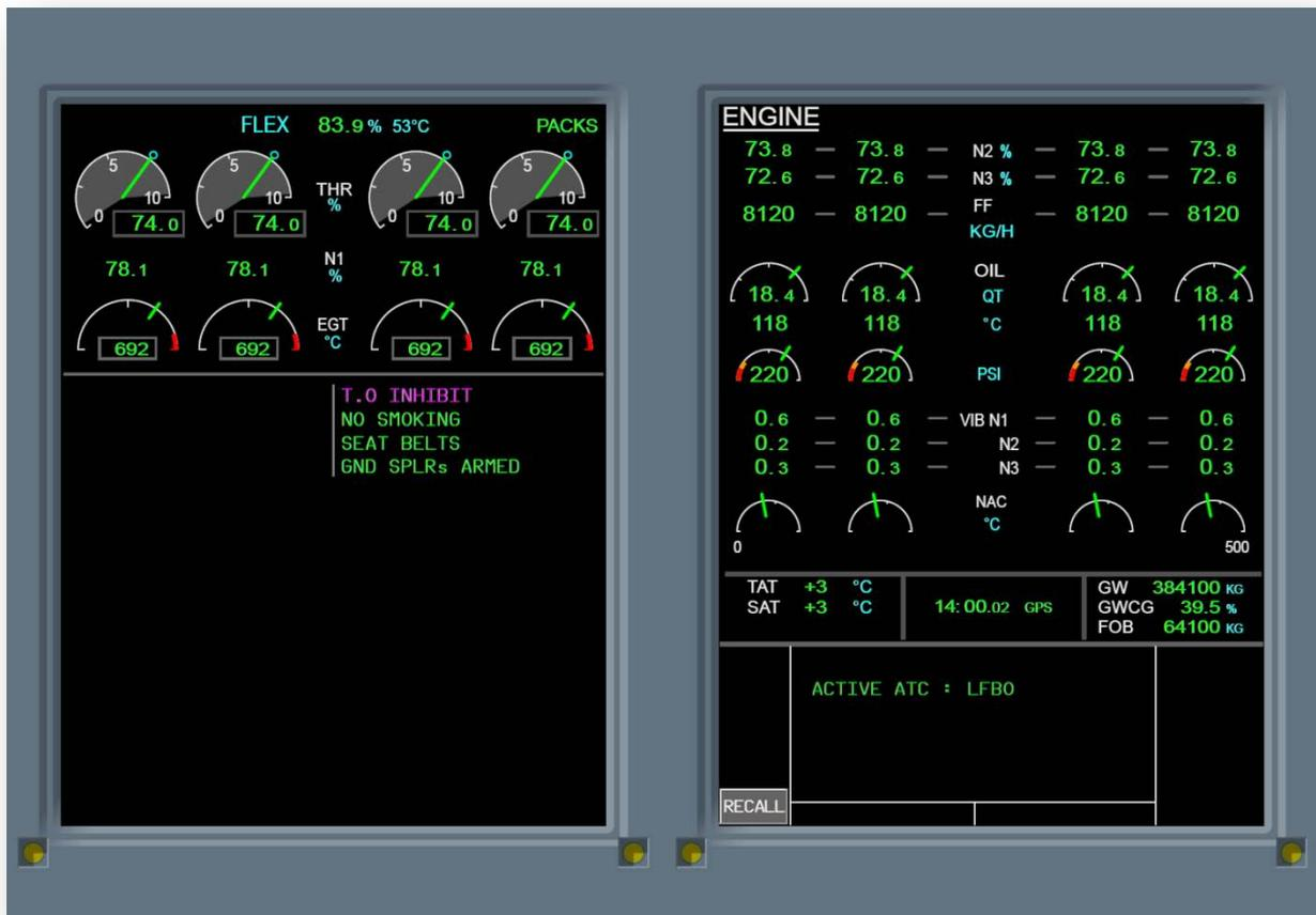
Abbildung 29: E/WD und SD des Airbus A380. Das Engine/Warning Display (links) unterscheidet sich kaum von jenem anderer Airbus Modelle. Rechts ist das System Display dargestellt. Im oberen Bereich können über das ECAM Control Panel (ECP) die einzelnen Systeme des Airbus angezeigt werden. Unten befindet sich die sogenannte ATC Mailbox. Sie dient vor allem zum Übertragen von elektronischen Daten. (Quelle: Airbus Industrie)
