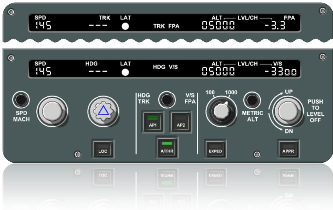
Abbildung 41: Flight Control Unit (FCU) – Neue Version. Zwei weitere Ziffern in der Anzeige sollen heute eine Verwechslung zwischen Sinkrate (V/S) und Gleitwinkel (FPA) verhindern. (Quelle: CBT Honeywell International Inc., Deutsche Lufthansa AG)
