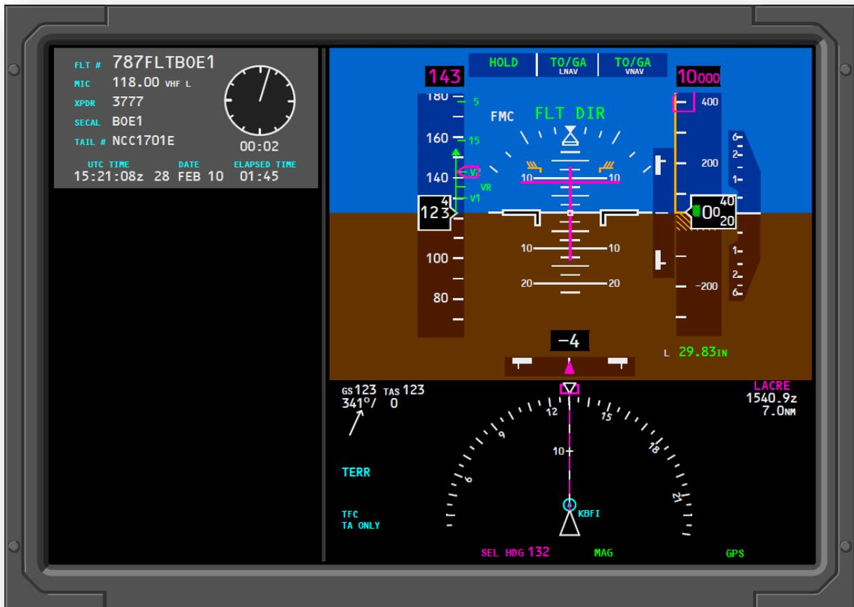
Abbildung 32: MFD mit Primary Flight Display der Boeing 787. (Quelle: The Boeing Company)
