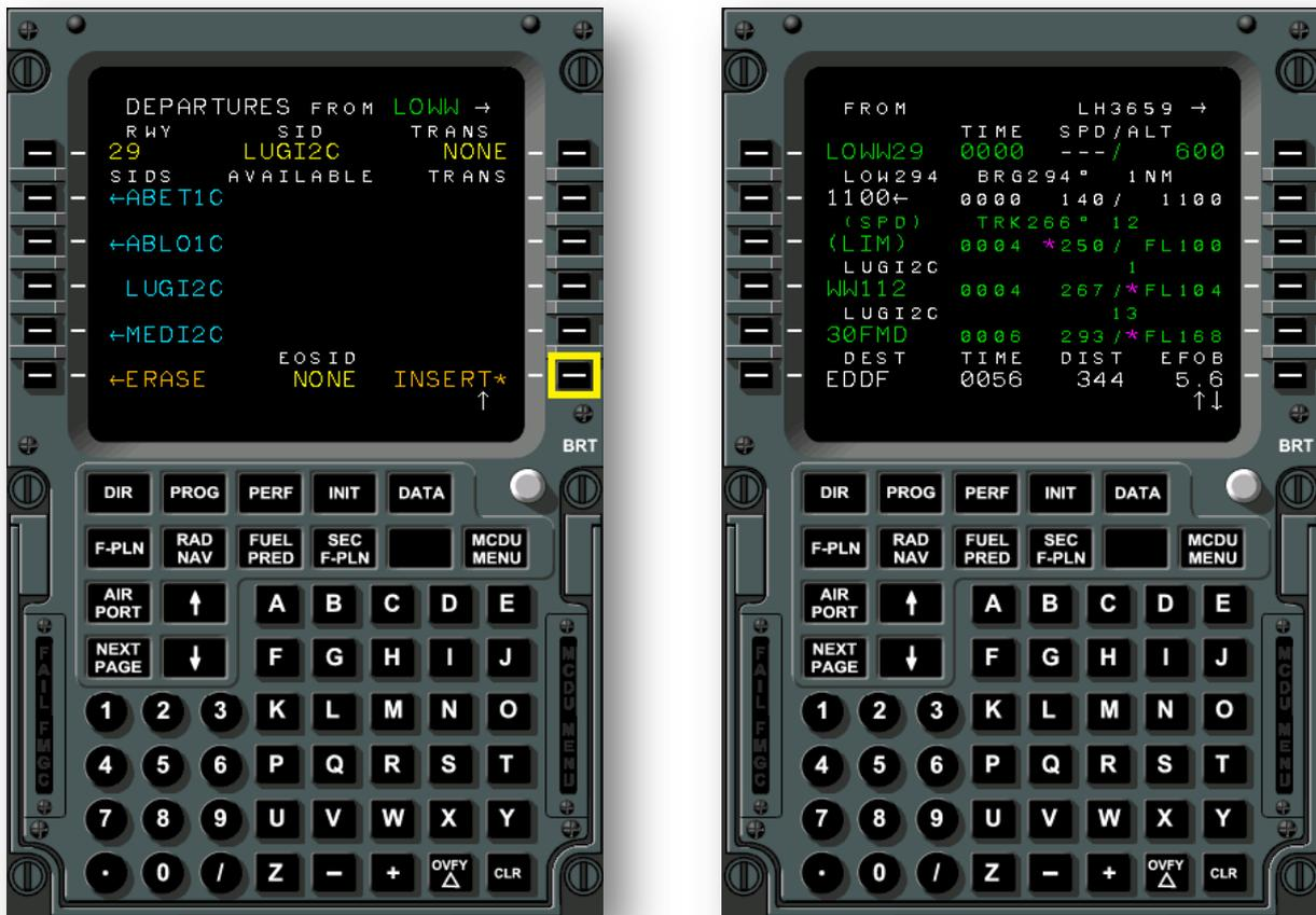
Abbildung 22: FMGS – Eingabe der Flugstrecke (Schritte 7 und 8) – Schritt 7 (links): Die Änderungen werden durch Druck auf den Schalter neben *INSERT* aktiviert. Schritt 8 (rechts): Das richtige Abflugverfahren von der Startbahn *LOWW29* ist jetzt eingegeben. (Quelle: CBT Honeywell International Inc., Deutsche Lufthansa AG)
