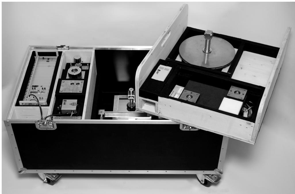
*Abbildung 157: Messausrüstung für die Planspiegelinterferometrie an kinematischen Strukturen*
