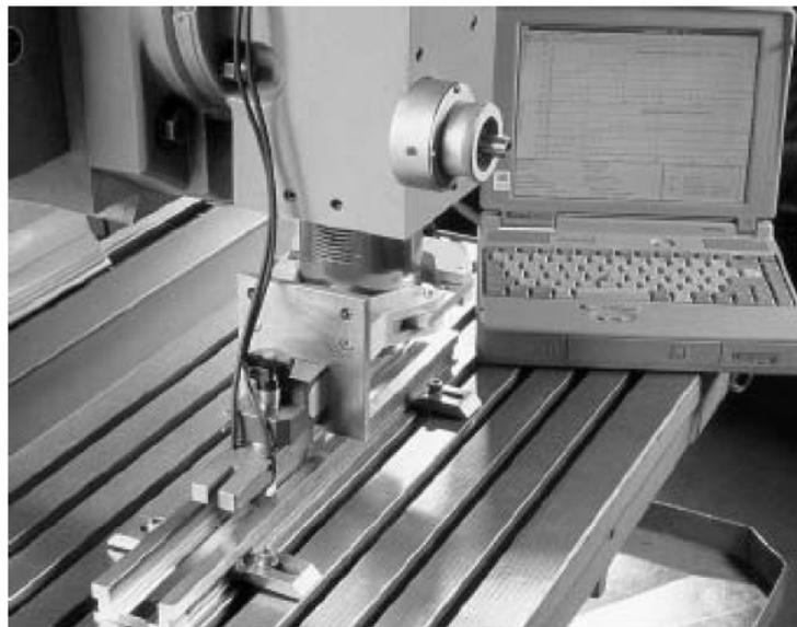
*Abbildung 93: Vergleichsmessgerät Heidenhain VM182 [81]*
