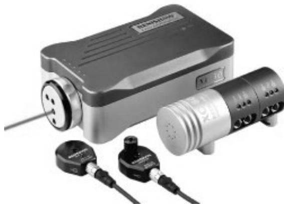
Abbildung 88: XL-80 Interferometer von Renishaw [111]
