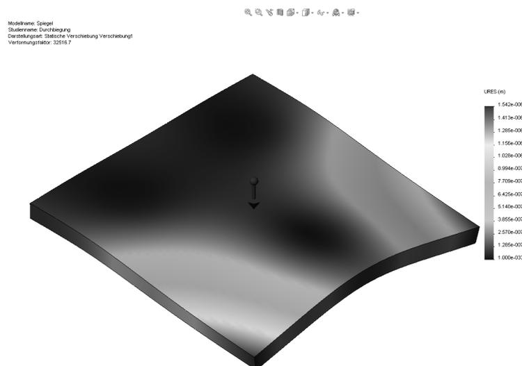
Abbildung 127: FEM-Modell zur Durchbiegung des Hochpräzisionsspiegels
