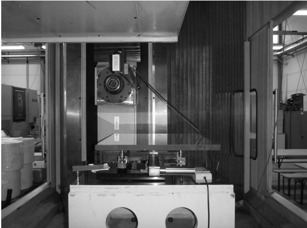
*Abbildung 152: Messaufbau des Planspiegelinterferometers in der Quickstep HS 500 für die Vermessung in Richtung Y*
