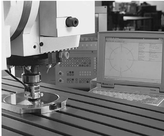
Abbildung 96: Kreuzgitter-Messgerät KGM 181/182 von Heidenhain [100]
