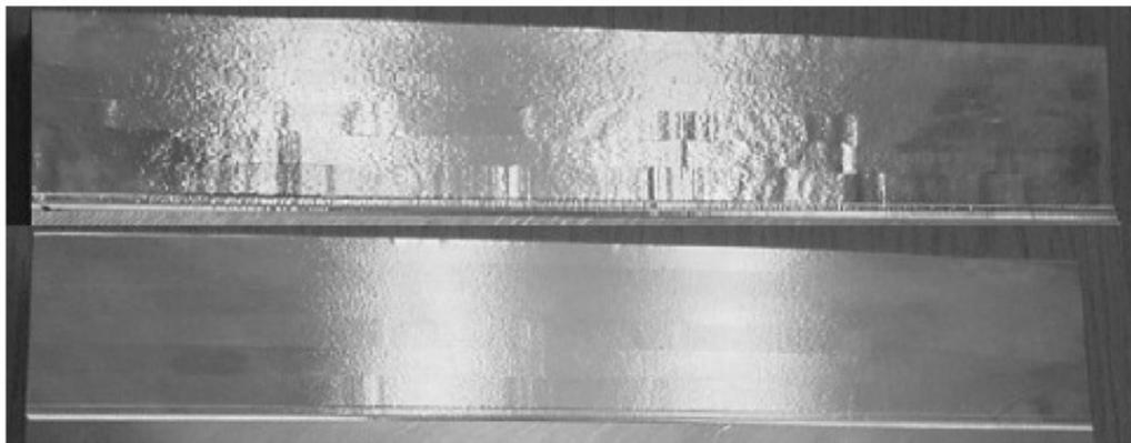
*Abbildung 77: Einfluss der Steuerungsparameter auf die Güte der Oberfläche am Beispiel der Parallelkinematik Linapod [87]*
