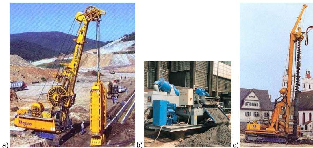
Abb. 69: Geräte – a) Hydraulik-Seilbagger; b) Bentonitanlage; c) Trägergerät mit durchgehender Schnecke 126
