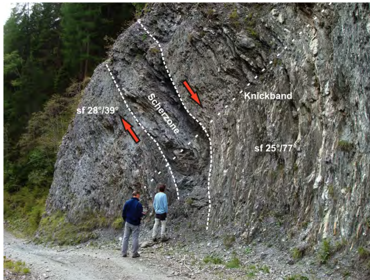
Abbildung 6.20: Topplingzone, überkippter Schenkel der Massenbewegung; Aufschließungsweg Bretterwandgraben, 1.500 m.ü.A.
