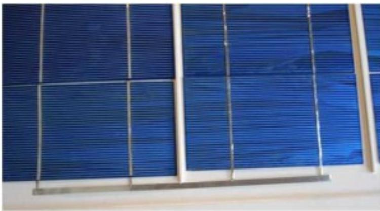
*Abbildung 32: Multikristalline Siliziumsolarzellen durch auf die Busbars gelöteten Kupferbänder standardkontaktiert*
