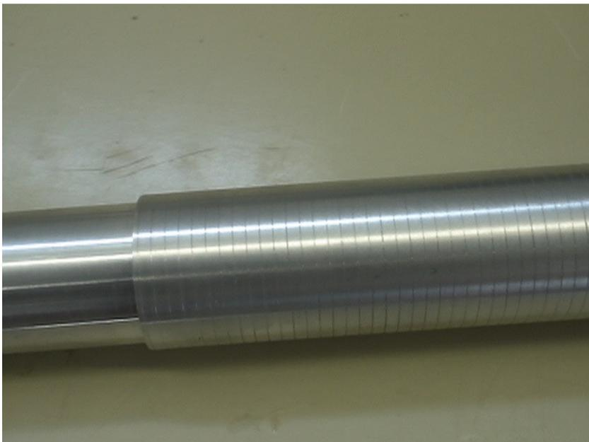
*Abbildung 42: Lötwalze mit Rillen zur Drahtführung*
