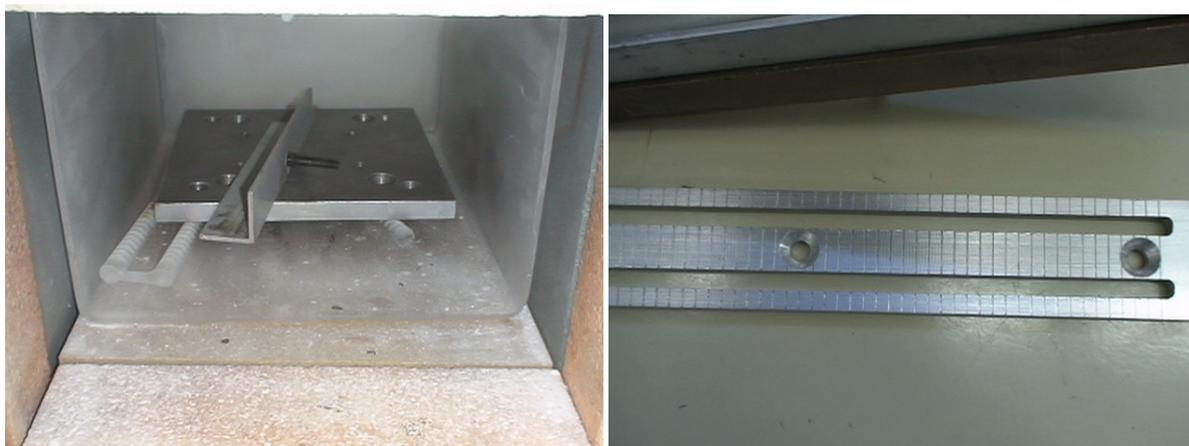
Abbildung 44: Lötstempel im Ofen (links); Drahtführung (rechts)
