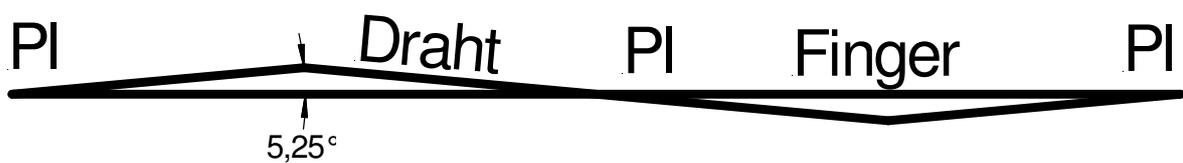
Abbildung 30: Horizontale Meandering in der Ebene des Wafers in der Aufsicht auf den Wafer; Pl...Punktlötungspunkt
