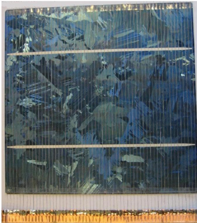
*Abbildung 33: Feindrahtkontaktierte Siliziumsolarzelle mit einseitiger Stromabführung und Kupfersammler*
