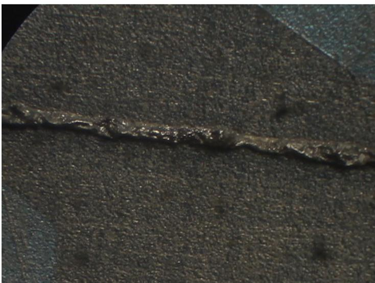
*Abbildung 36: Deformierter Kupferfeindraht*
