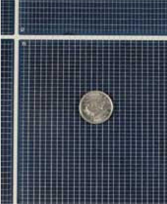
*Abbildung 15: Day4Energy Zelle; Das Gitter wird von Fingern und Drähten aufgespannt
