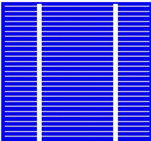
*Abbildung 6: Kontaktierungsmuster einer multikristallinen Siliziumsolarzelle*
