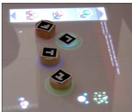
Abbildung 5.14: ChemTable am 4T Rückprojektionstisch (ARToolKit)
