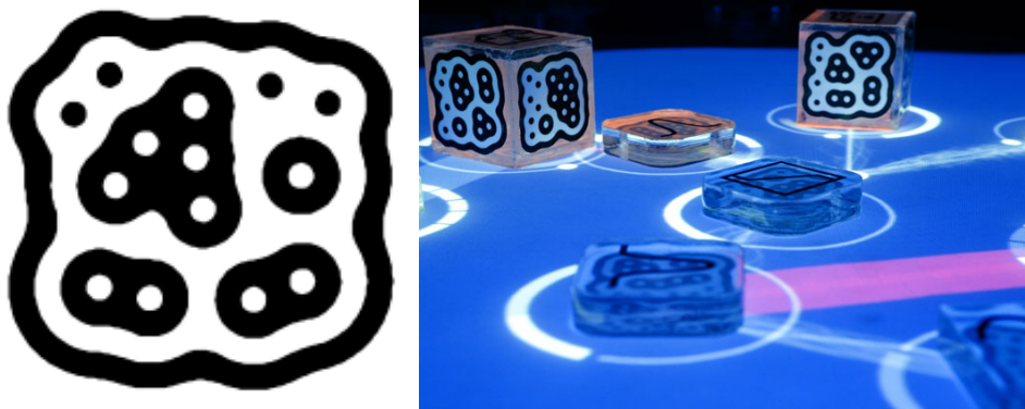
Abbildung 2.11: Fiducial (l.) und tangibles Objekt aus Plexiglas (r.)
