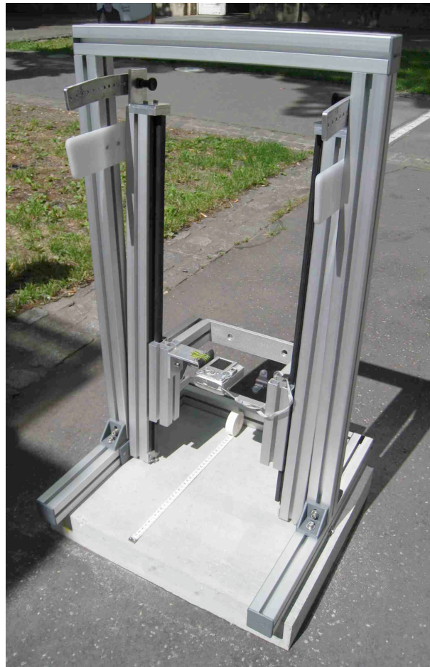
Abbildung 3.3: Prüfstand zum Aufzeichnen der stereoskopischen Halbbilder mit befestigter Digitalkamera
