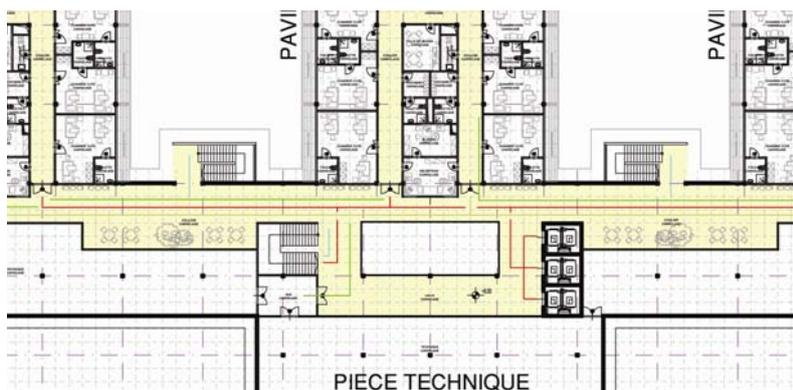
Da die drei oben genannten Stiegenhäuser bei einem Notfall als Fluchtstiegen nicht ausreichen, wurden zwischen den einzelnen Stationsflügeln auch Fluchtstiegen eingeplant. Diese wurden so positioniert, damit die 30 Meter Fluchtweg bis zu den Stiegenhäuser nicht überschritten wird.
