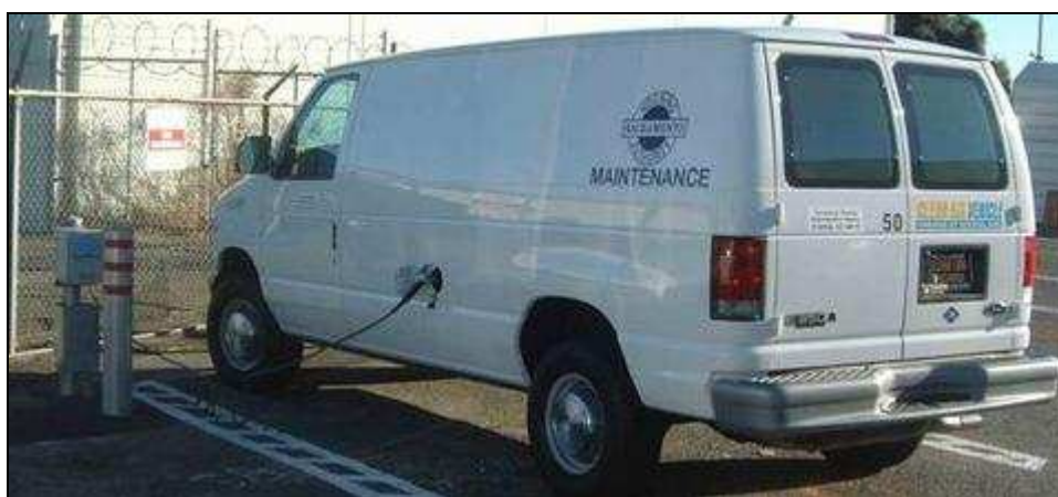
Abb. 4.12: CNG-Slow-Fill-Tankanlage; Quelle: [Q 123]
