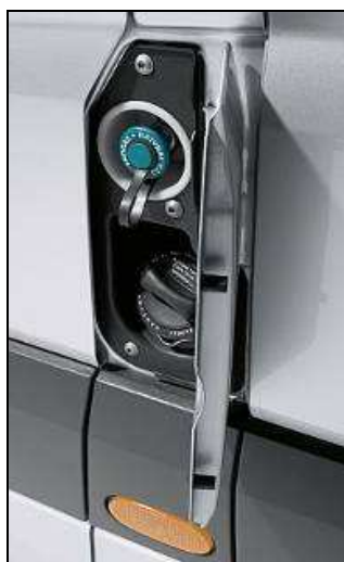
Abb. 4.11: CNG- und Benzin-Tank-Einlässe am Fahrzeug; Quelle: [Q 122]
