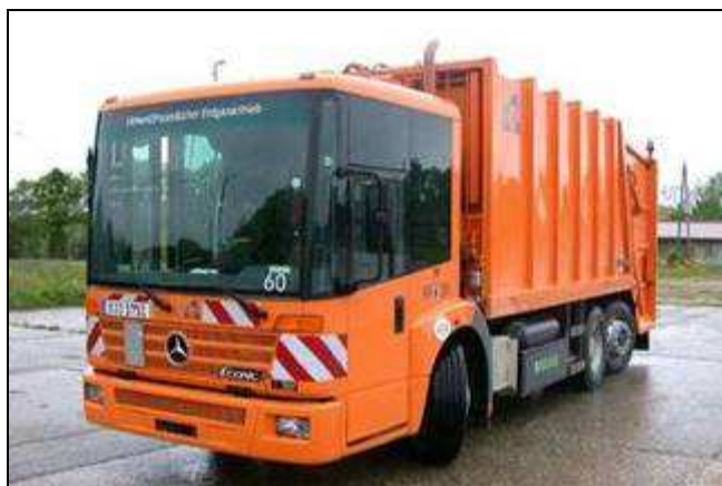
Abb. 4.15: Mercedes Econic NGT im Einsatz als Müllsammelfahrzeug; Quelle: [Q 133]
