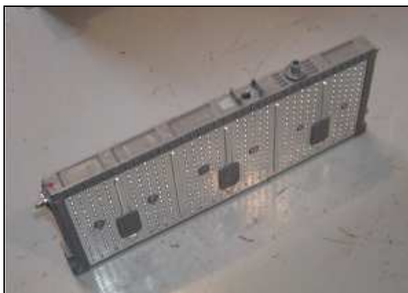
Abb. 5.6: NiMH-Batterie, 6 Zellen in Serie; Quelle: [Q 156]
