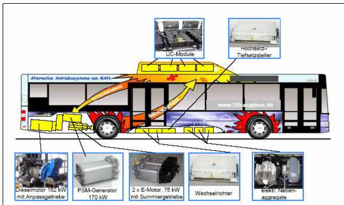
Abb. 5.28: Prinzip des Ultracap-Bus; Quelle: [Q 201]
