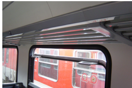
(b) Überkopfablage Großraum
