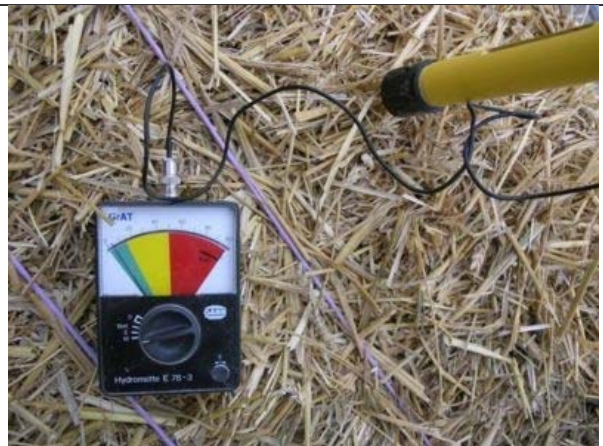
Feuchtigkeitsmessung der Strohballen
