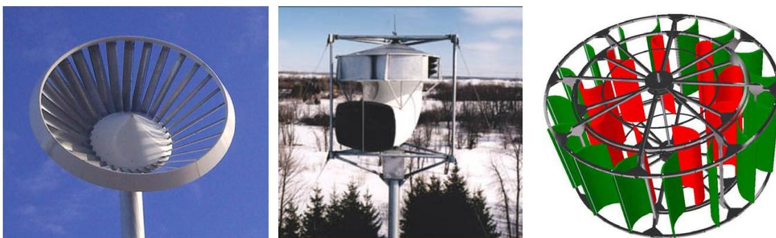
Abbildung 21: Links: Multiblatt-Horizontalachsenanlage mit trichterförmigem Rotor [30]. Mitte: Aufwendige Konstruktion mit gebogenem Ansaugstutzen [16]. Rechts: Anlage mit vertikaler Achse und Stator aus Windleitblechen [23, S. 1].
