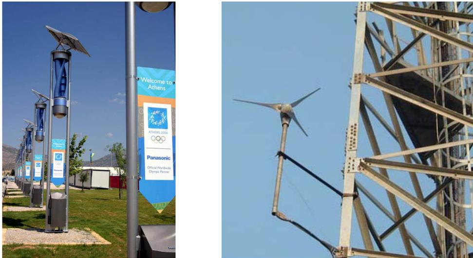
Abbildung 25: Zwei interessante Einsatzbeispiele für Kleinwindkraftanlagen als Batterielader: *Links*: Architektonisch ansprechende Strassenlaternen mit integriertem Savonius-Rotor und PV-Modul, im Einsatz bei den olympischen Spielen in Athen 2004 [46]. *Rechts*: Eine Air X (vgl. Abschnitt 2.3.1) zur Energieversorgung eines Sendemastes [70].
