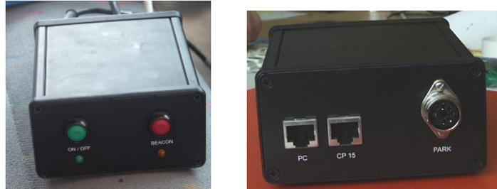
Abbildung 6 Remote Control Box (vorne/hinten)
