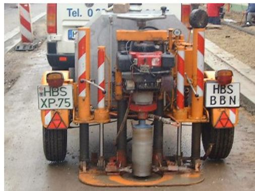
**Abbildung 19: Bohrwagen bei Bohrkernentnahme [14]**
