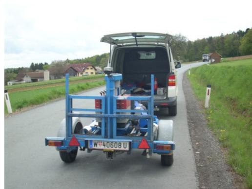
Abbildung 16: ISTU - Bus während einer Messfahrt
