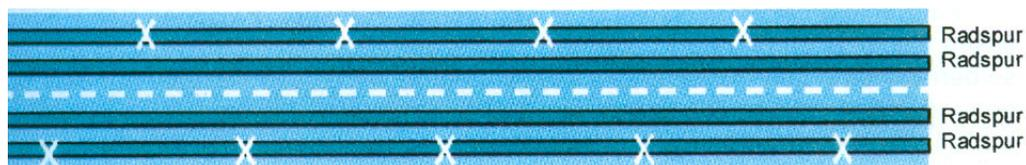
Abbildung 20: Anordnung versetzter Messpunkte [1]
