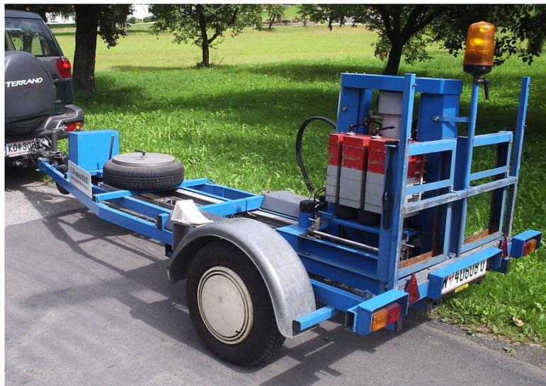
**Abbildung 1: Dynatest 8002 FWD Test System des Instituts für Straßenbau und Straßenerhaltung der TU Wien**
