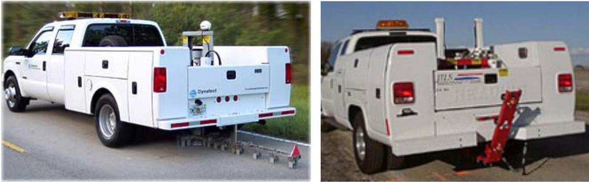
**Abbildung 4: In Zugfahrzeug integriertes FWD der Firmen Dynatest (linkes Bild) und der Firma JILS (rechtes Bild) [3][8]**
