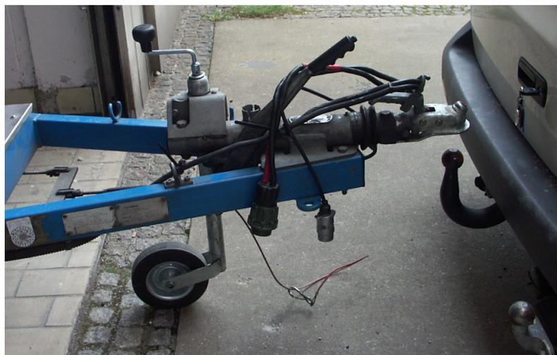
Abbildung 8 Anhängervorrichtung, Sicherungsleine, Stützrad
