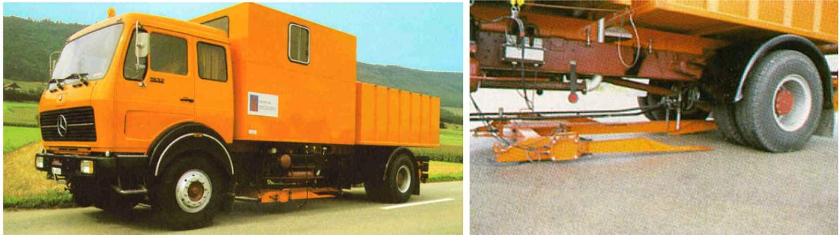
**Abbildung 10: Deflektograph LACROIX: Messwagen (links) und Messbalken in Aufnahmestellung (rechts) [5]**
