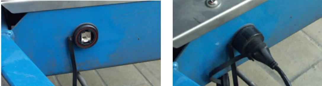
Abbildung 15 Anschluss Netzwerkkabel
