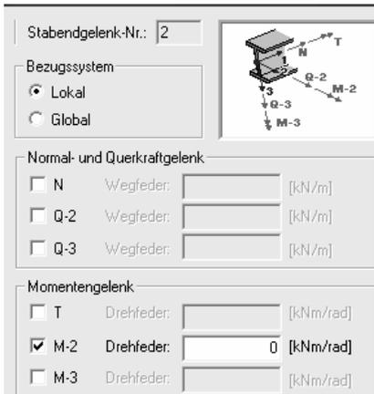
Abbildung 36: Unteres Gelenk der vertikalen Balkenverbindung
