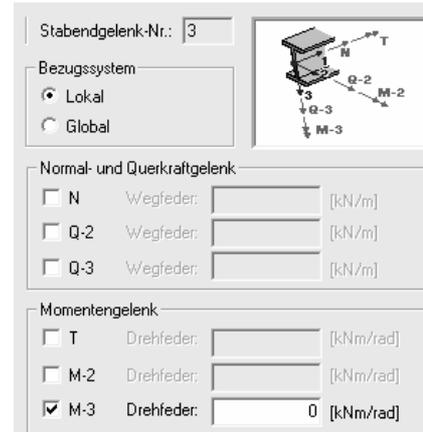
Abbildung 37: Oberes Gelenk der vertikalen Balkenverbindung
