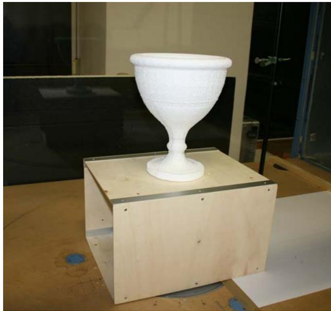
Abbildung 6.4: Styropormodell im Windkanal montiert
