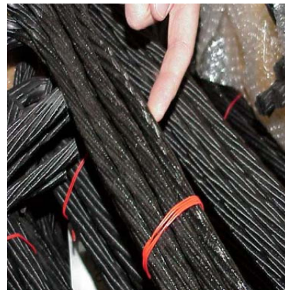
b) Bewehrung aus kohlenstoffverstärkten Kunststoffen
