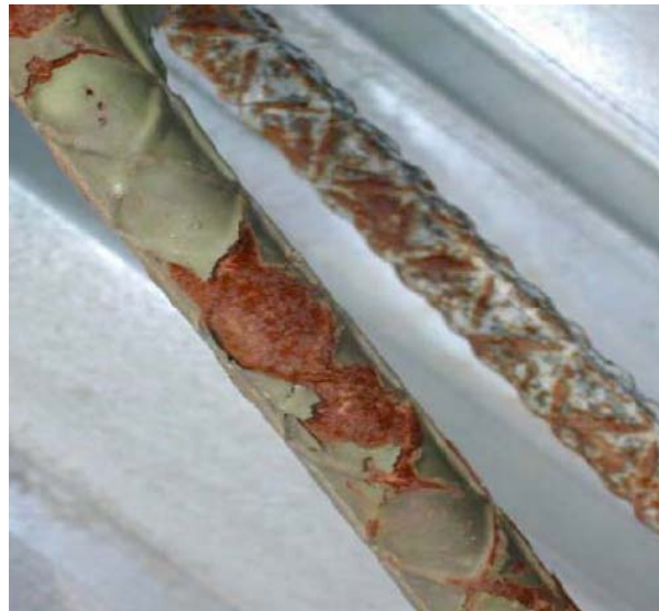
Abb. 7: Epoxidharz beschichtete Bewehrung aus einer Brücke in Colorado, USA [www.ovbb.at]
