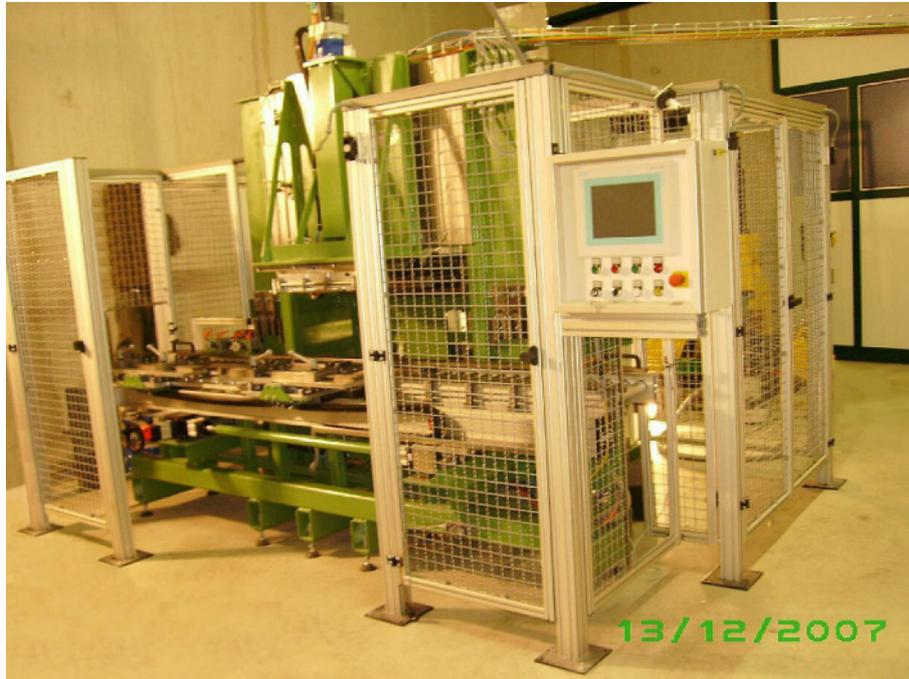
**Bild 1.1: Spiegelschweißmaschine mit Bedieneinheit an der Schutzumhausung**
