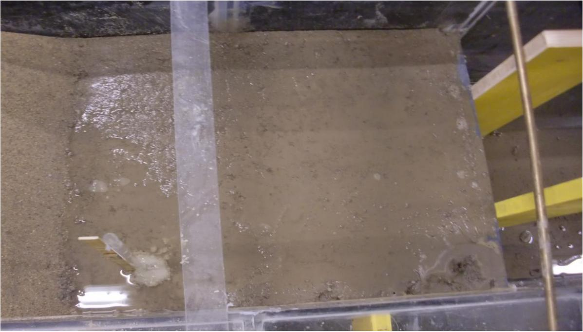
Abbildung 9.30: Draufsicht des Versagens (Deckschichtoberfläche im Bereich der Landseite)
