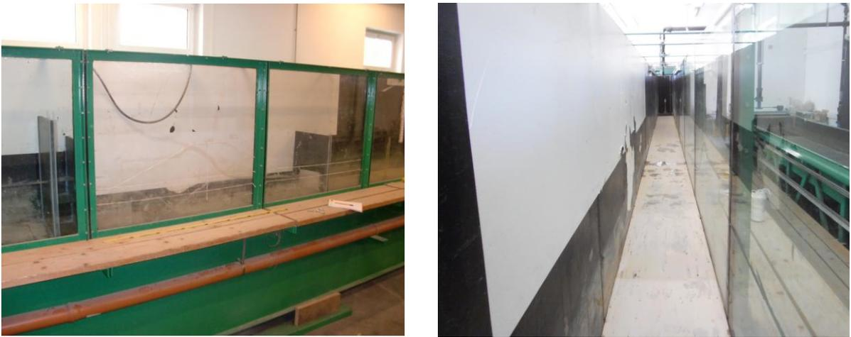
Abbildung 9.3: Glasrinne im Wasserbaulabor; (links) Seitenansicht; (rechts) Innenansicht
