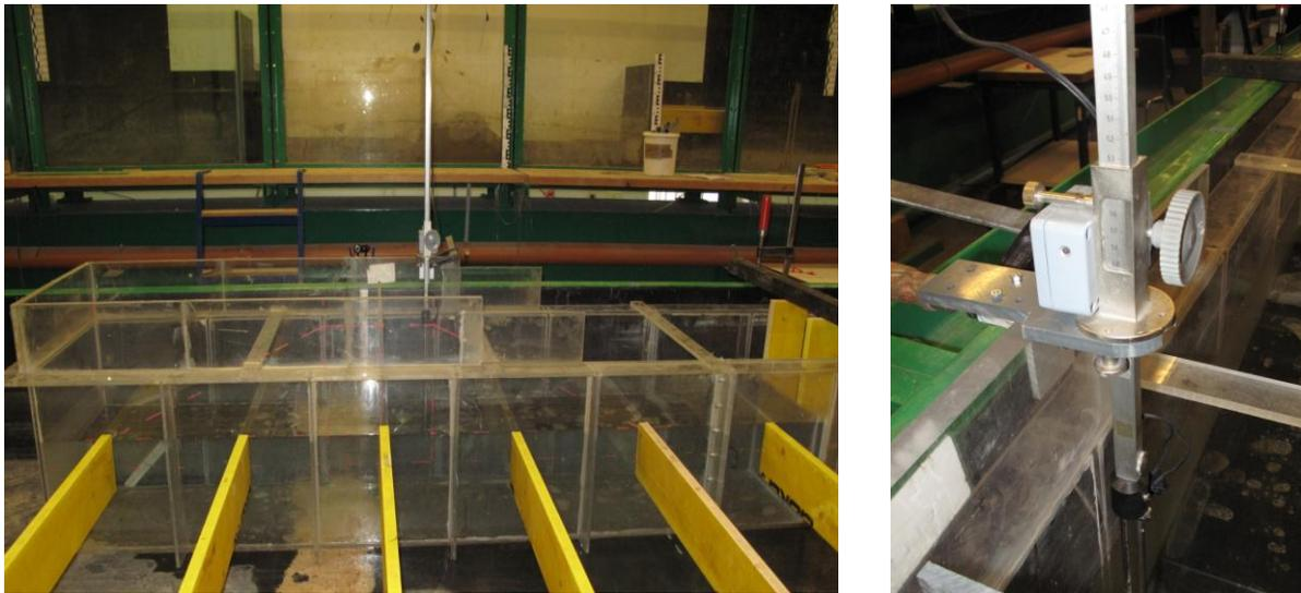
Abbildung 9.20: Dichtigkeitsprüfung in der Plexiglasrinne (links) und Füllstandsmessgerät (rechts)
