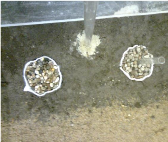
Abbildung 9.43: Entlastungssäulen –  $D = 7 \text{ cm}$
