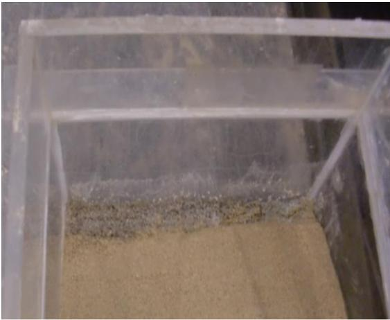
Abbildung 9.27: Öffnung zum Grundwasserleiter
