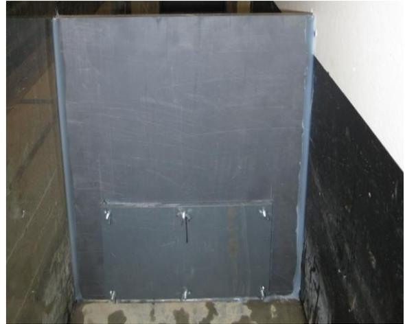
Abbildung 9.8: Auslass mit Platte (Außenansicht)
