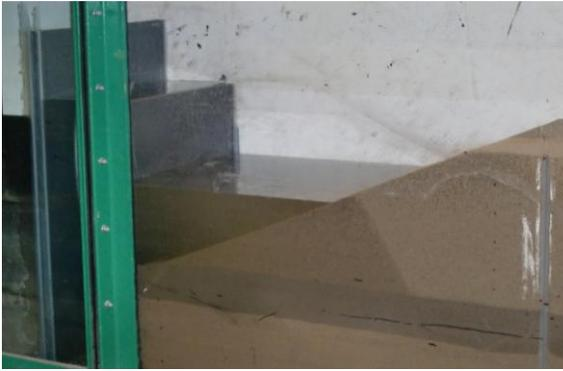
Abbildung 9.13: Sickerlauf beim Auffüllen
