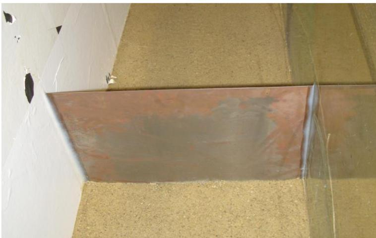
Abbildung 9.10: Einbau der Dichtwand in der Glasrinne
