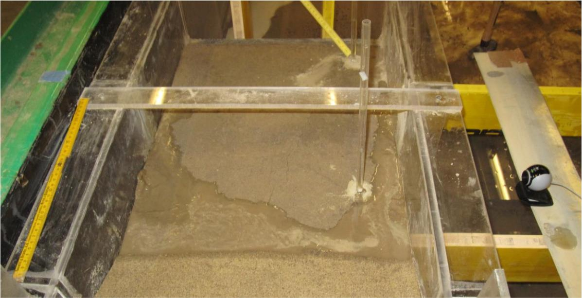
Abbildung 9.37: Hydraulischer Grundbruch infolge Aufschwimmen der Deckschicht
