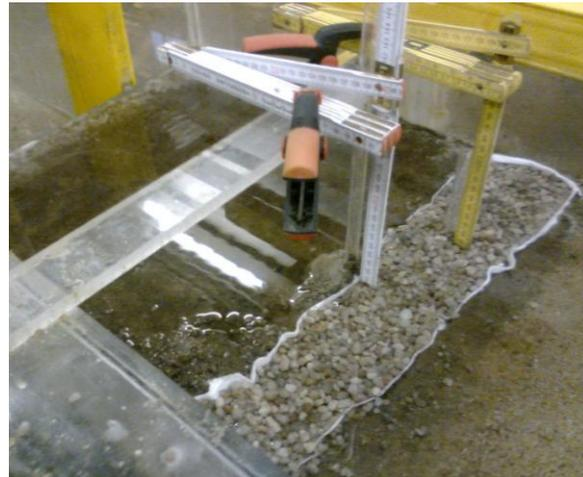
Abbildung 9.44: Entlastungsgraben –  $B = 7 \text{ cm}$
