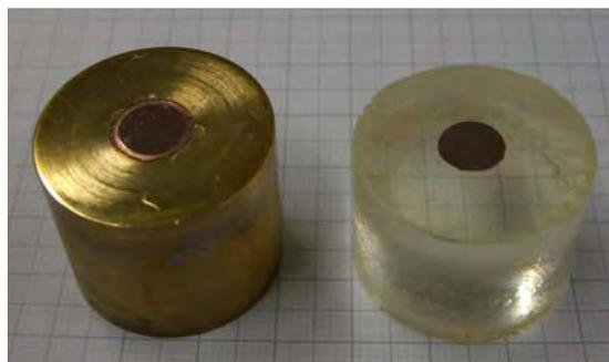
Abbildung 24: Probe auf Messingträger aufgeklebt-links und Probe in Epofix eingebettet-rechts
