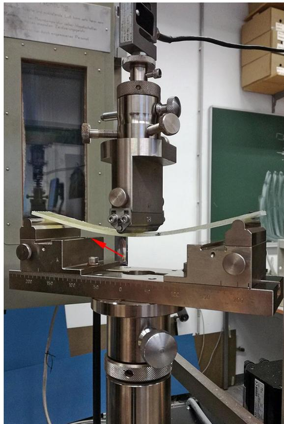
Abbildung 60: Dreipunkt-Biegeversuch im Labor.
