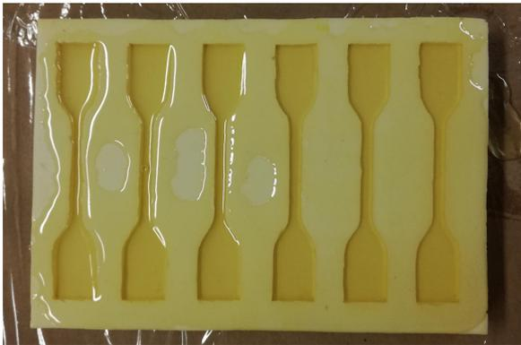
Abbildung 10: Gegossene Zugproben in Silikonform nach dem Aushärten im Ofen.
