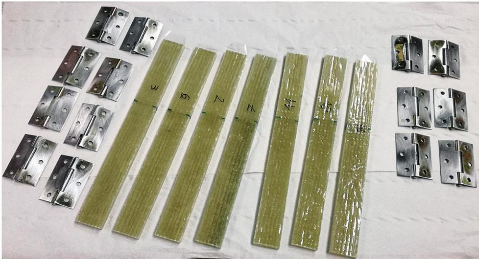
Abbildung 47: DCB-Probenfertigung vor dem Ankleben der Scharniere.
