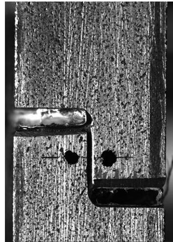
Abbildung 17: Fertige Probe nach dem Entfernen der Beilagen mit angebrachten Markierungen.
