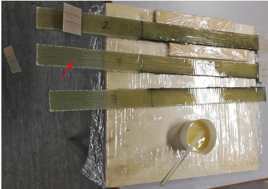
Abbildung 29: Fertigung der ENF-Proben. Oben sind bereits beide Fügeteile zu einer Probe verbunden, darunter liegen zwei Platten mit Klebstoff bestrichen. Der Pfeil markiert eine Kupferlitze.
