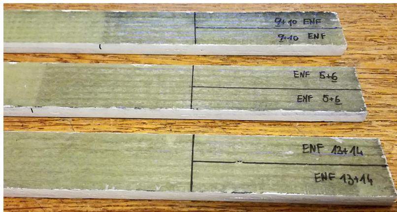
Abbildung 73: Vorbereitung der ENF-Mikroskopproben vor dem Schneiden.
