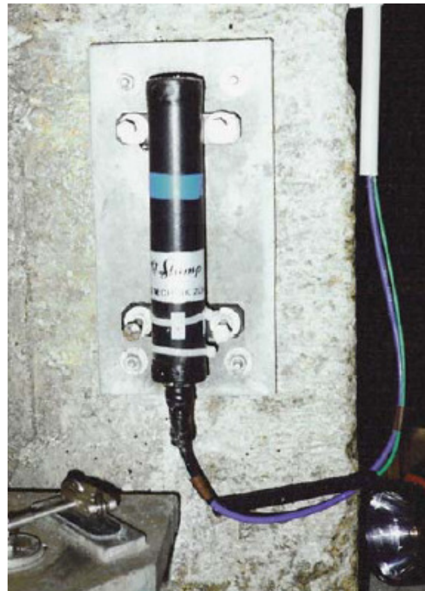
Abb. 5-20: Elektrisches Tiltmeter ( 2-axiale Messung) (aus: Schweizer Talsperrenkomitee, 2005)
