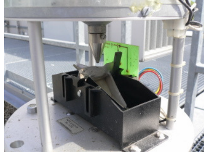
Abb. 5-4: Wippprinzip (aus: FH-Offenburg, 2011)
