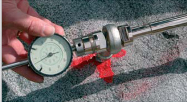
Abb. 5-9: Ablesung mit Messuhr (aus: Geodata, 2011)
