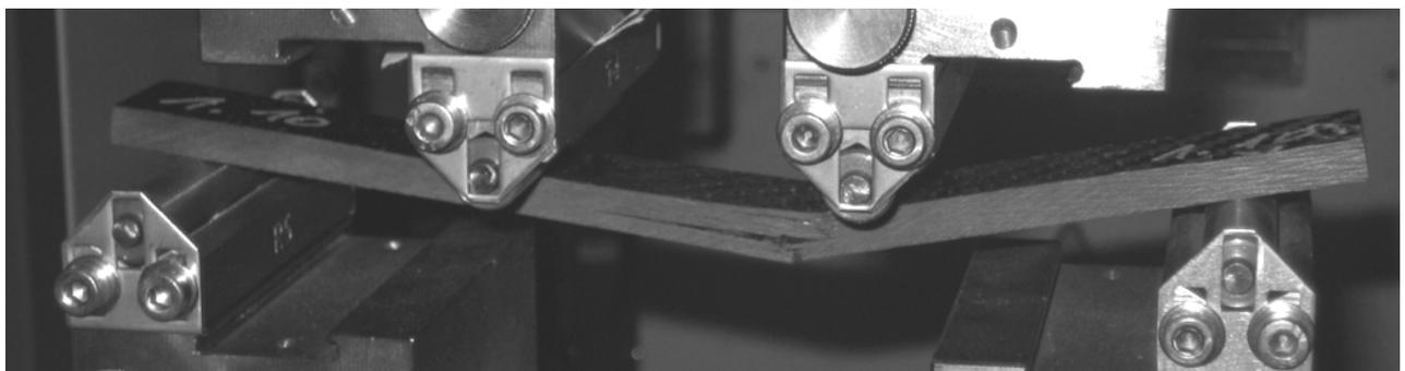
Abbildung 5.28 Biegeprobe des Materials
