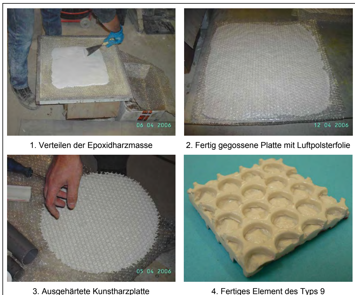
Abb. 23: Fotodokumentation über die Herstellung von Element Typ 9
