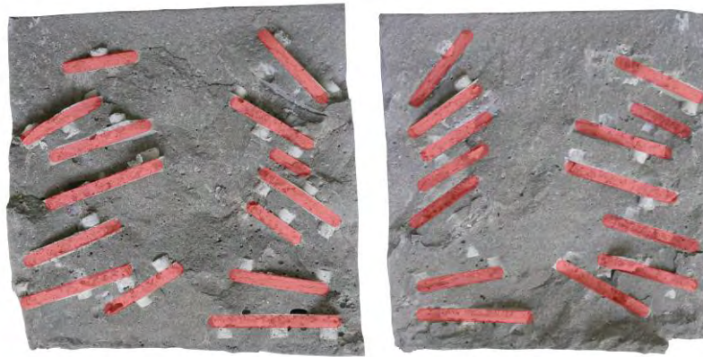
Abb. 88: Bruchfläche von PK 6; linkes Bild: linkes Rissufer; rechtes Bild: rechtes Rissufer
