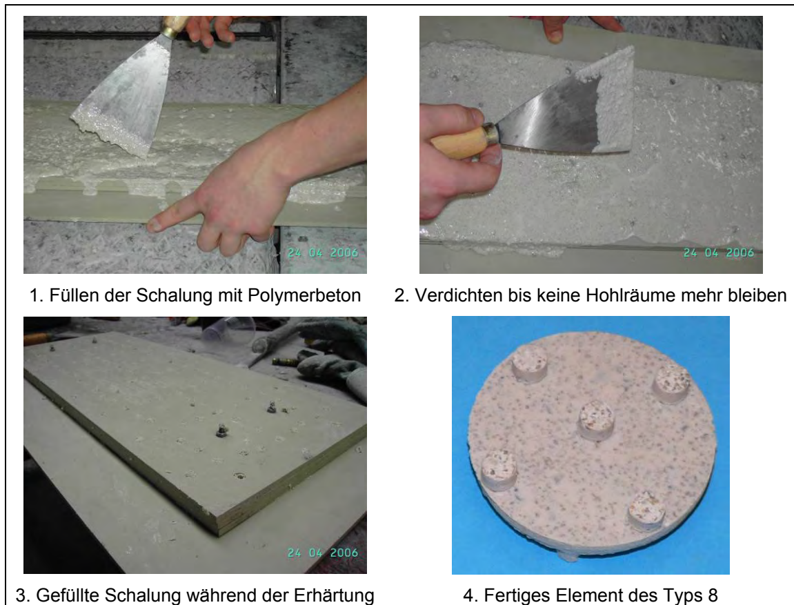
Abb. 22: Fotodokumentation über die Herstellung von Element Typ 8
