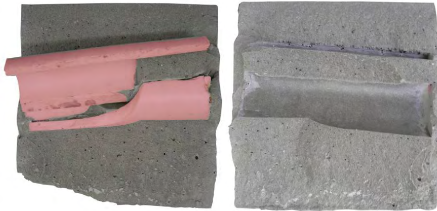
Abb. 100: Bruchfläche von PK 9; linkes Bild: linkes Rissufer; rechtes Bild: rechtes Rissufer
