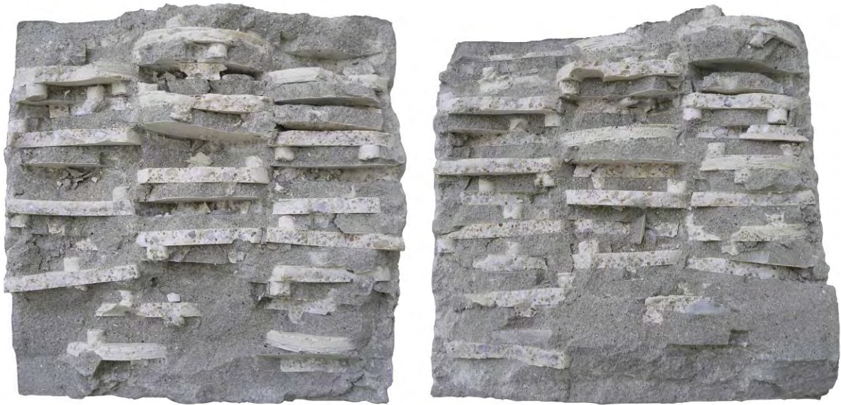
Abb. 107: Bruchfläche von PK 11; linkes Bild: linkes Rissufer; rechtes Bild: rechtes Rissufer
