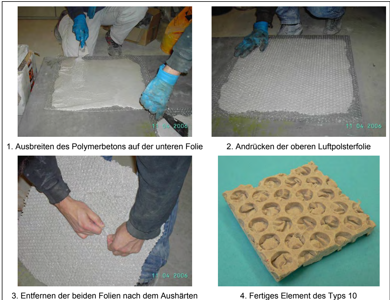
Abb. 24: Fotodokumentation über die Herstellung von Element Typ 10
