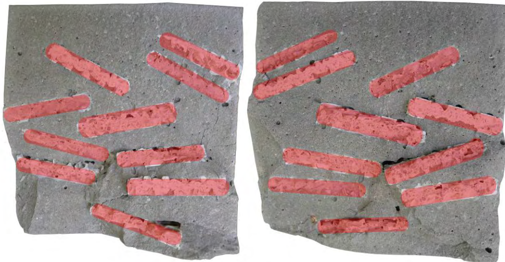
Abb. 95: Bruchfläche von PK 8; linkes Bild: linkes Rissufer; rechtes Bild: rechtes Rissufer
