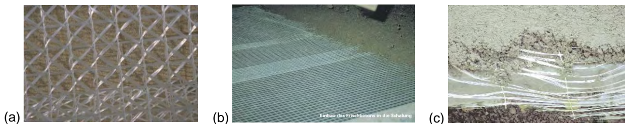
Abb. 12: a) Detail eines multiaxialen Glasfasergewebes; b) Glasfasergewebelagen während des Betoniervorganges; c) Glasfasergewebe einbetoniert in Beton mit Kurzfasern; (alle Abb. aus Lit. [13])
