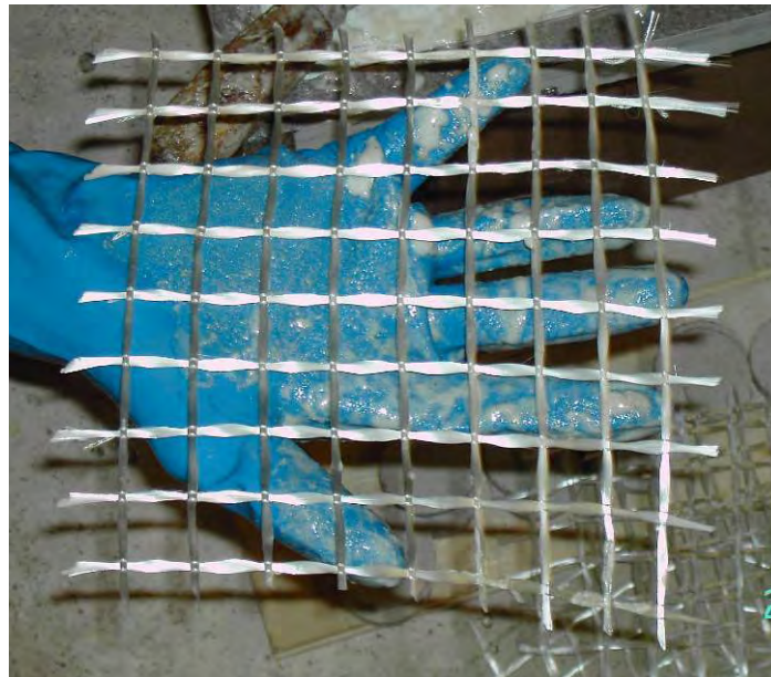
Abb. 13: Glasfasergewebestück mit den Abmessungen 20x20 cm für die Herstellung der Verstärkungselemente
