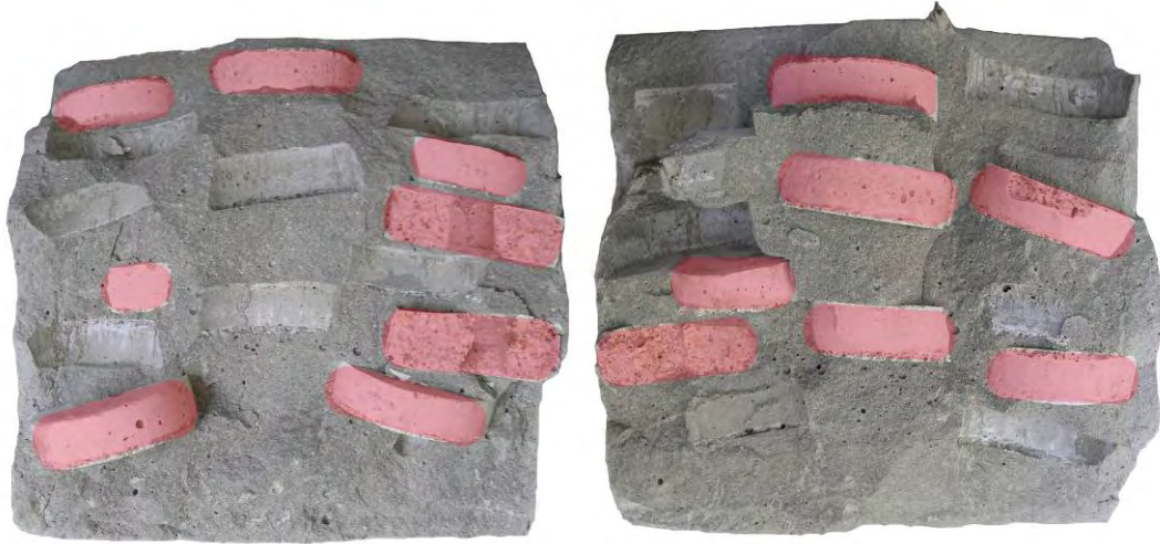
Abb. 80: Bruchfläche von PK 4; linkes Bild: linkes Rissufer; rechtes Bild: rechtes Rissufer
