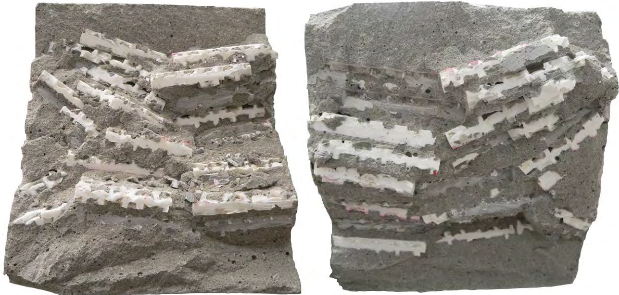
Abb. 111: Bruchfläche von PK 12; linkes Bild: linkes Rissufer; rechtes Bild: rechtes Rissufer
