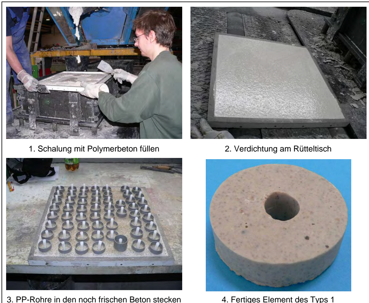
Abb. 18: Fotodokumentation über die Herstellung von Element Typ 1
