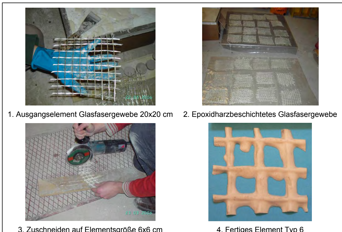
Abb. 20: Fotodokumentation über die Herstellung von Element Typ 6
