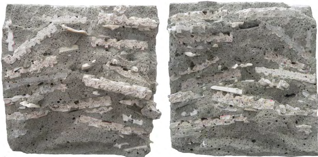
Abb. 115: Bruchfläche von PK 13; linkes Bild: linkes Rissufer; rechtes Bild: rechtes Rissufer
