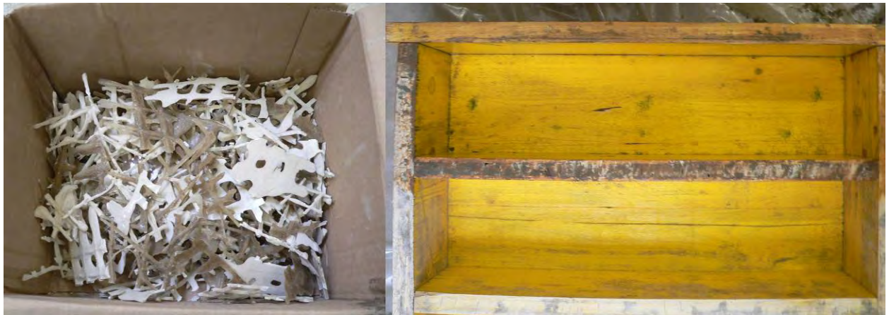
1. Reststücke für die Zwischenbetonschicht (links) und Schalung für die Probekörperherstellung (rechts)
