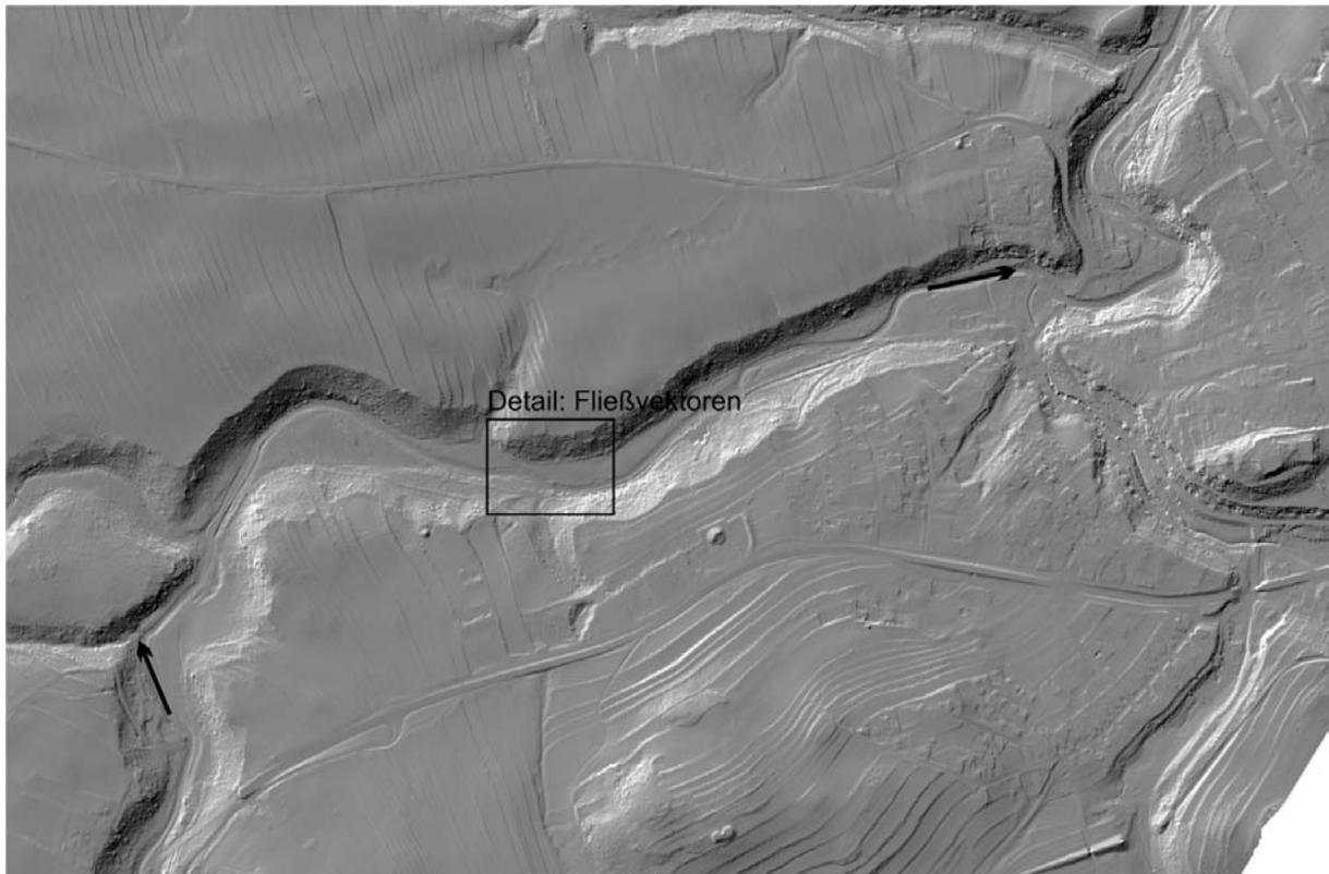
**Abbildung 6.18:** Beispiel 4, Mittellauf der Lainsitz, DGM-W (Hybrides Geländemodell: 1m-Raster, Brückenwiderlager als Geländekanten)
