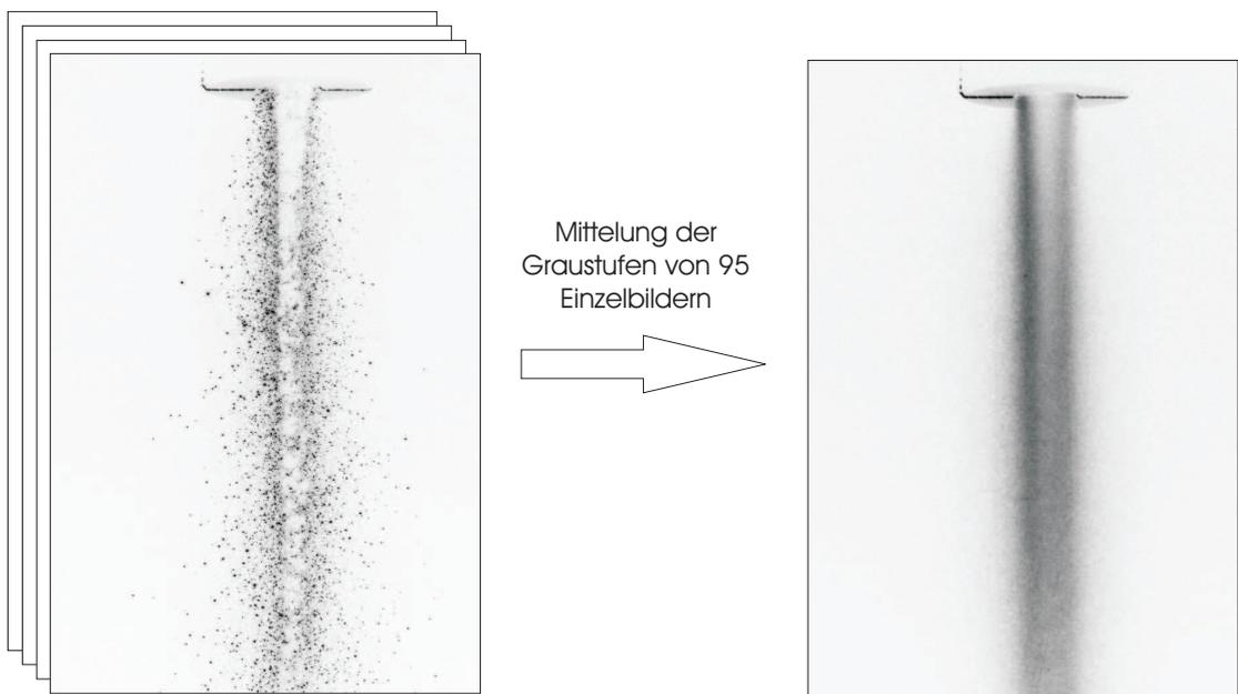
**Abbildung 6.2.:** links: 95 Einzelbilder, rechts: gemitteltetes Graustufenbild, welches den Fallvorgang für jeweils einen bestimmten Massenstrom darstellt
