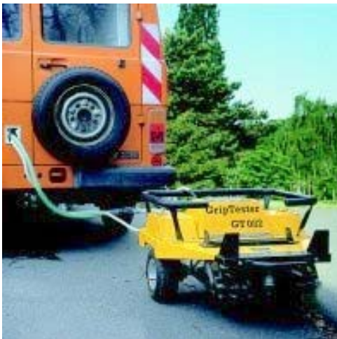
Abbildung 15: Grip-Tester am Anhänger und im Handschiebebetrieb [23]
