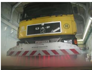
Abbildung 11: Schräge Messsensoren am RoadSTAR-Messsystem [15]
