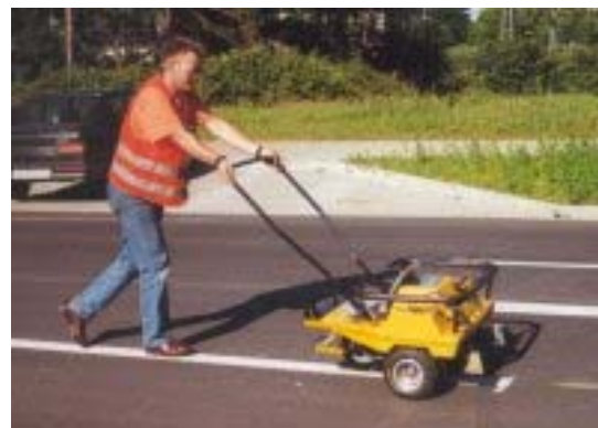
Abbildung 15: Grip-Tester am Anhänger und im Handschiebebetrieb [23]
