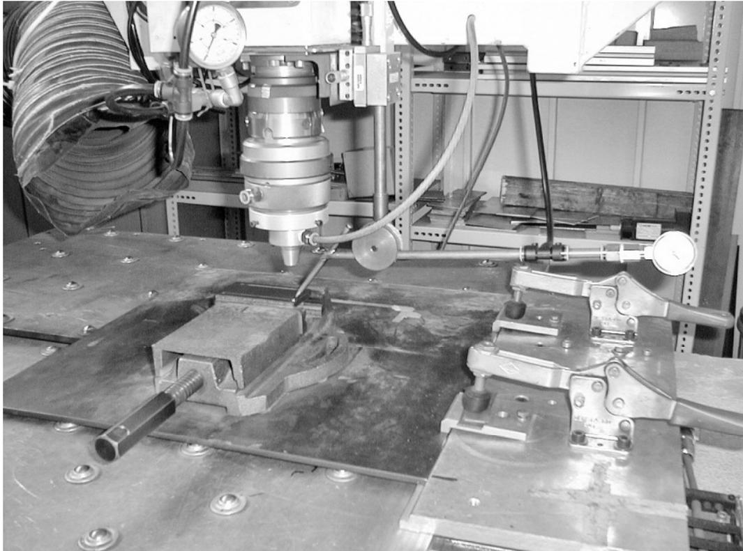
*Dieses Bild zeigt den Aufbau rund um die Bearbeitungsstelle. Links oben wurde die Absaugung montiert. Hier erkennt man auch sehr gut die abgewinkelte Prozessgasdüse und die Anbringung des Manometers für die Messung des Gasdruckes.*
