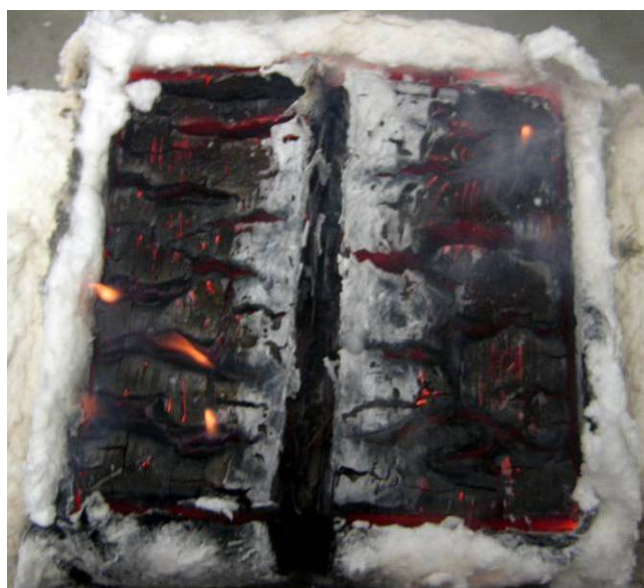
Abbildung 3.6: Mittig gerissene Vorholzplatte des Probekörpers ILV-2 – HSV 35/5 – 1 nach 60 Minuten Brandbeanspruchung.
