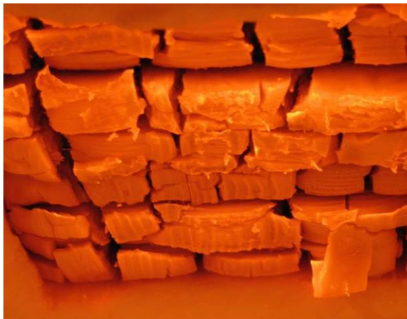
Abbildung 3.7: Schichtenweiser Abbau der Vorholzplatte während des Brandversuchs. Deutlich erkennbarer unterschiedlicher Jahrringverlauf in der Oberfläche des Probekörpers ILV-2 – HSV 20/20 – 2.
