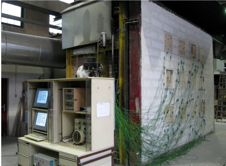
Abbildung 3.16: Großer Brandofen der Versuchs- und Forschungsanstalt der Stadt Wien mit eingebauten Probekörpern.
