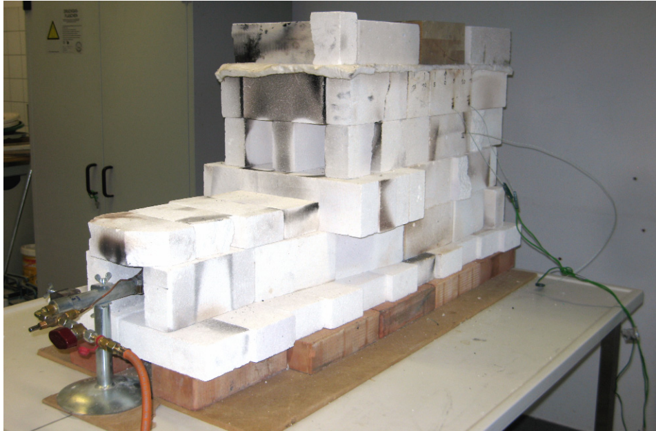
Abbildung 3.1: Foto des im Zuge dieser Arbeit entwickelten Laborofens zur Durchführung von Brandversuchen im BWB der TU-Wien.
