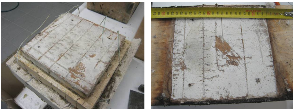
Abbildung 3.11: Die Verkohlung des Holzrückens entlang der Stahlplatte des mit Aluminiumsilikatfasermatten ummantelten Probekörpers ILV-3 – HSV 21/20 – 2 (Bild rechts) lässt auf einen geringen zusätzlichen seitlichen Energieeintrag direkt in die Stahlplatte schließen. Probekörper ILV-3 – HSV 21/20 – 1 (Bild links) zeigt keinerlei Verkohlungen am Holzrücken.
