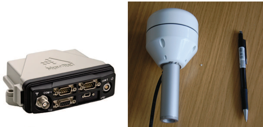
Abb. 3.3: Novatel FlexPak-G2 Empfänger sowie GPS-Antenne AT575-142 von Aero Antenna.
