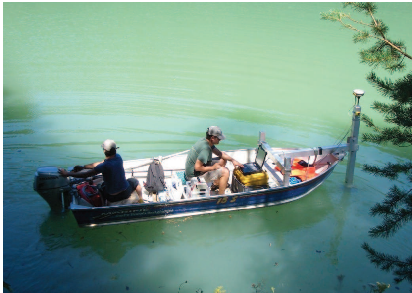
Abb. 1.1: Hydrographische Vermessung mit Einzelecholot und GPS-RTK. Quelle: FLUSSBAU – MAYR UND SATTLER OEG.
