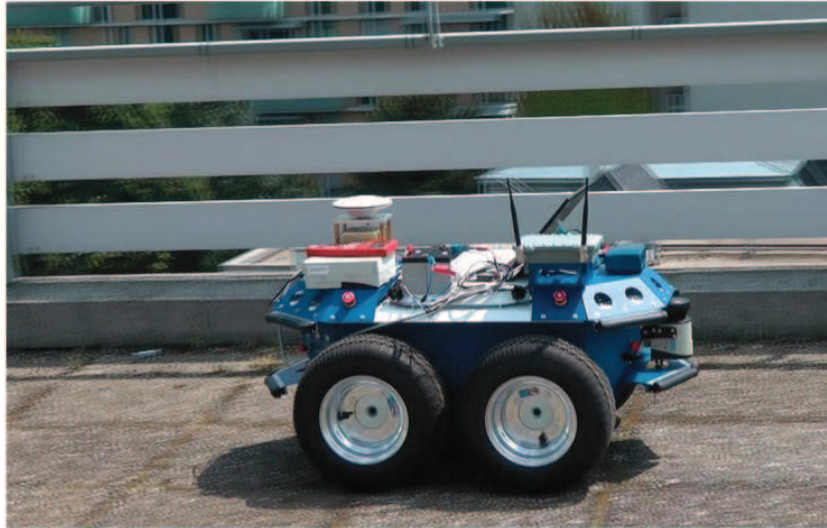
Abb. 5.1: Kinematische Messung mit dem GPS-IMU System am Dach der TU Wien.
