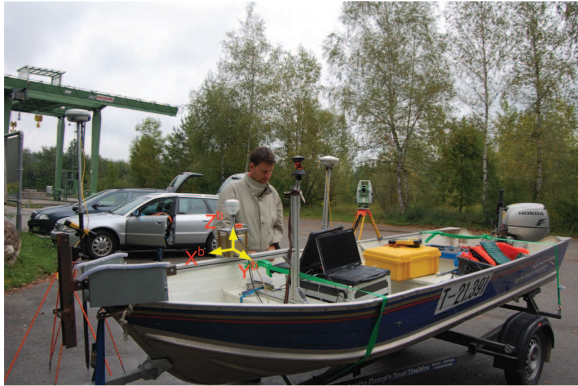
Abb. 5.6: Messaufbau der Verortungssysteme auf dem Messboot.
