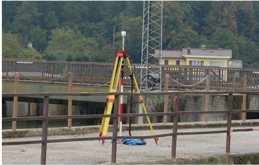
Abb. 5.8: Eigene Referenzstation auf der Staumauer des Laufkraftwerkes Rosegg.
