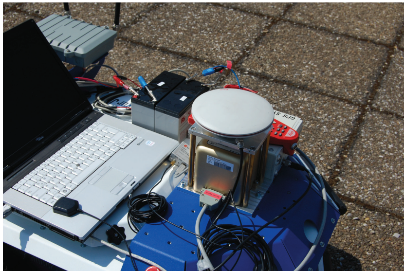
Abb. 5.2: Befestigung der Sensoren am Messroboter.
