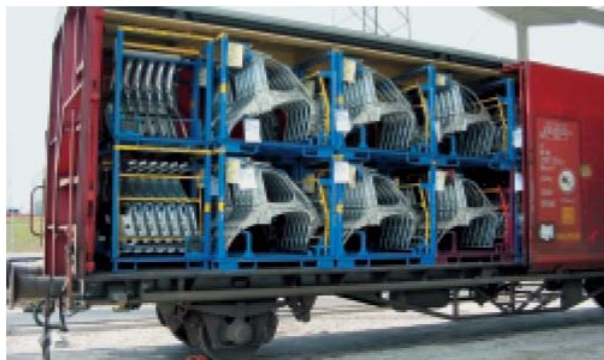
Abb. 36: Spezialracks für den Transport von Karosserieteilen für den Touareg-Express (Quelle: Rinofner 2005, S. 2)
