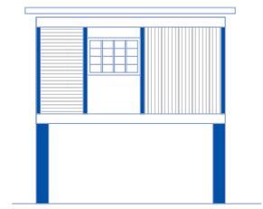
Die vertikale Gliederung erfolgt gewissermaßen über die Piloten/ Stützen und wird an der Fassade durch Eckpfosten bzw. seltener durch dazwischen sitzende Pfosten komplementiert.
