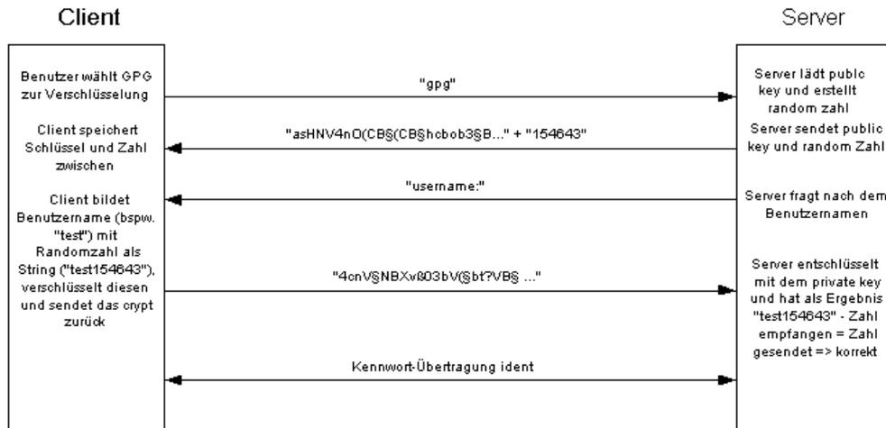
Abbildung 2.11: Verschlüsselte Kennwortübertragung
