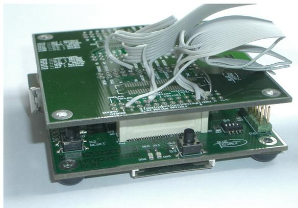
**Abbildung 5.4:** Hardwarelösung für den Client ohne Videoverarbeitung
