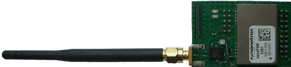
**Abbildung 4.2:** Funk-Testmodul nanoPAN 5361
