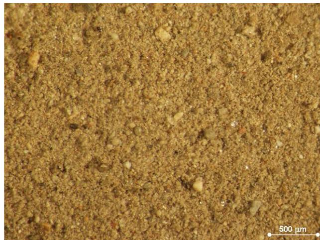
**Bild 76** Abgeschiedene Partikel des Sekundärzyklons (7 bar)
