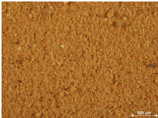
**Bild 67** Abgeschiedene Partikel nach Veraschung (5 bar)
