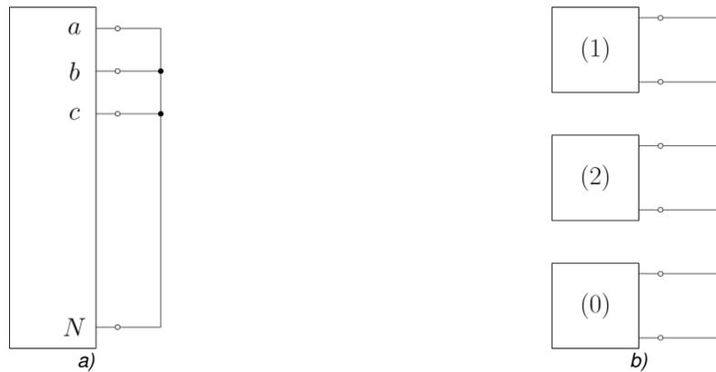
Abbildung 13: 3 - poliger Kurzschluss mit Erdberührung
