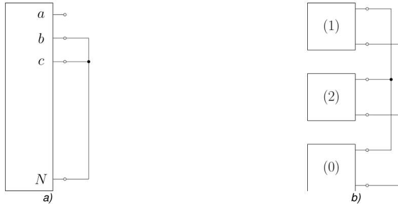
Abbildung 15: 2 - poliger Kurzschluss mit Erdberührung
