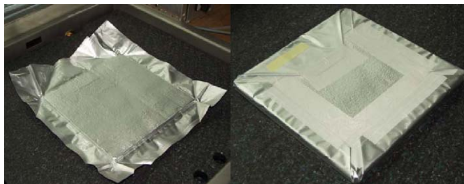
Abbildung 6: Vakuum-Isolationspaneel im 3-Rand-Siegelbeutel, aus [11]
