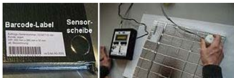
Abbildung 12: Sensorscheibe am Paneel und externes Sensorgerät, aus [21]
