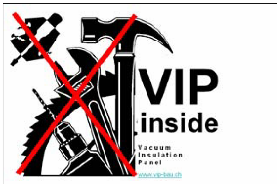
Abbildung 18: Warnkleber zur Kennzeichnung von Paneelen oder Bauteilen mit Paneelen, aus [29]
