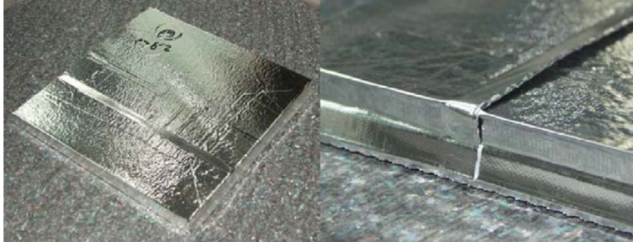
Abbildung 7: Vakuums-Isolationspaneel in straff um den Stützkern gezogener Folie, aus [11]
