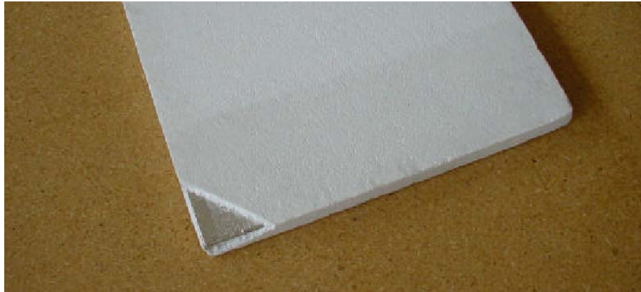
Abbildung 13: Paneel mit Schutzumhüllung aus Polystyrol-Hartschaum, aus [22]
