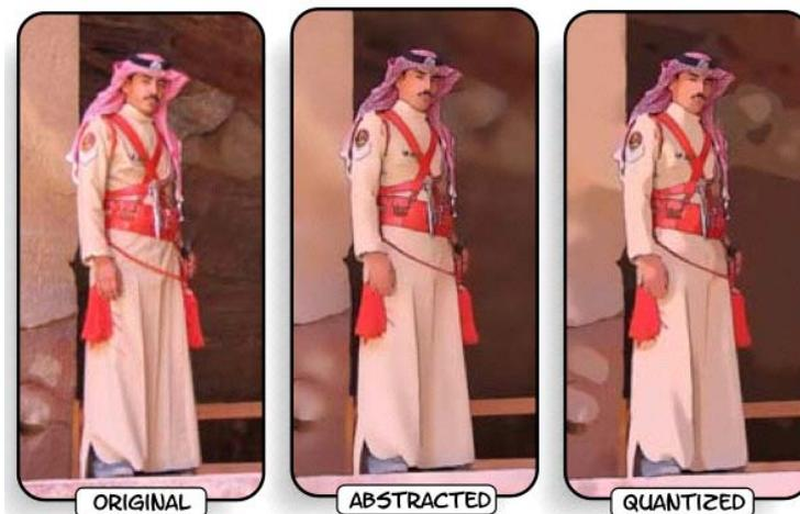
Abbildung 2.14: Diese Abbildung aus [93] zeigt ein Bild im Verlauf der Verarbeitung. Das abstrahierte Bild (*abstracted*) entsteht durch mehrmalige Faltung mit einem Bilateralen Filter und anschließendem Hinzufügen von *DoG-Kanten* des Originalbilds. Das quantifizierte Bild (*quantized*), ganz rechts, wird auf 12 Helligkeitswerte reduziert.
