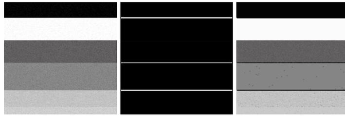
Abbildung 3.5: Das *erste Bild* ist das Originalbild mit Gauß'schem Rauschen. Das *zweite Bild* zeigt das Ergebnis der Faltung mit einem vertikalen Sobel Filter. Das *letzte Bild* ist das Ergebnis der Kantenerkennung nach Anwendung der geglätteten Stufenfunktion mit  $\phi_e = 1.75$ .
