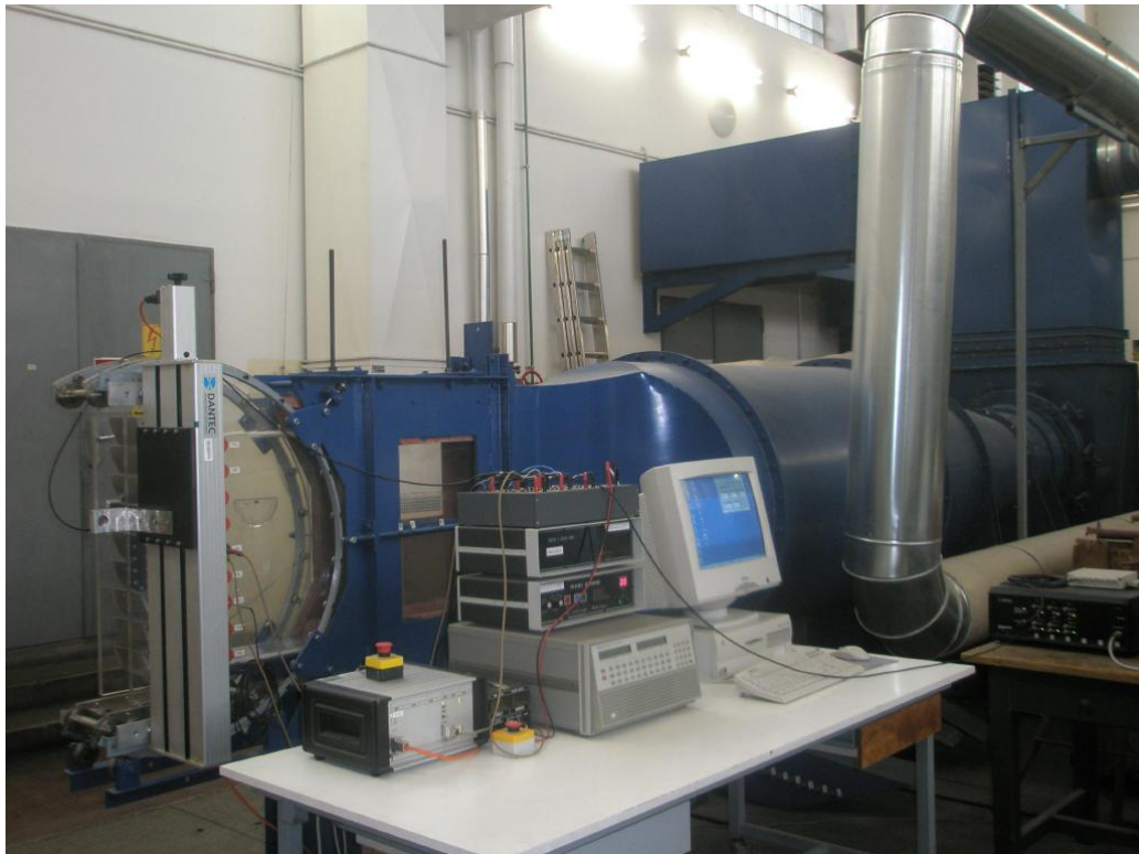
Abbildung 6.1: Schaufelgitterwindkanal im thermischen Labor des Instituts
