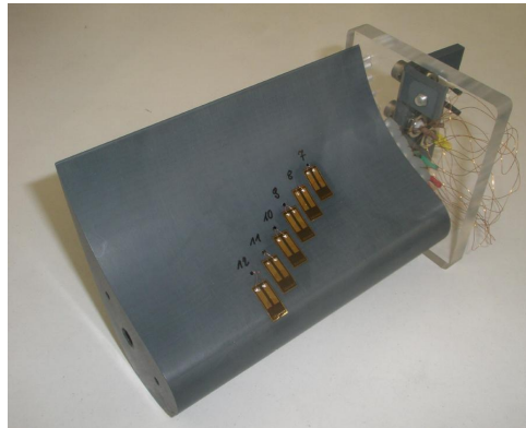
Abbildung 6.6: Instrumentierte Turbinenschaufel mit sechs aufgeklebten Heißfilmsonden
