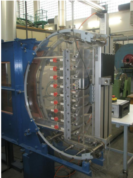
Abbildung 6.3: Ebenes Schaufelgitter mit neun Turbinenschaufeln
