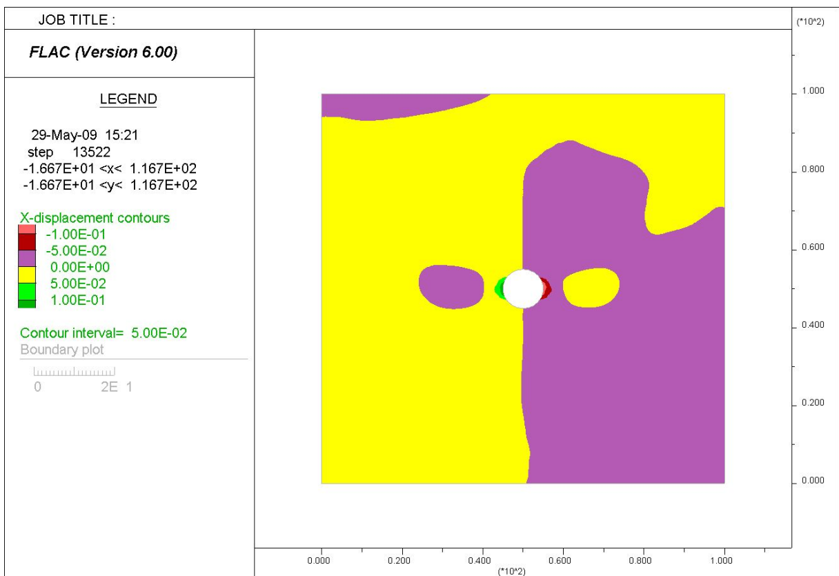
Abbildung 4.5: Bereiche gleicher Horizontalverschiebungen [m] nach 13522 Berechnungsschritten
