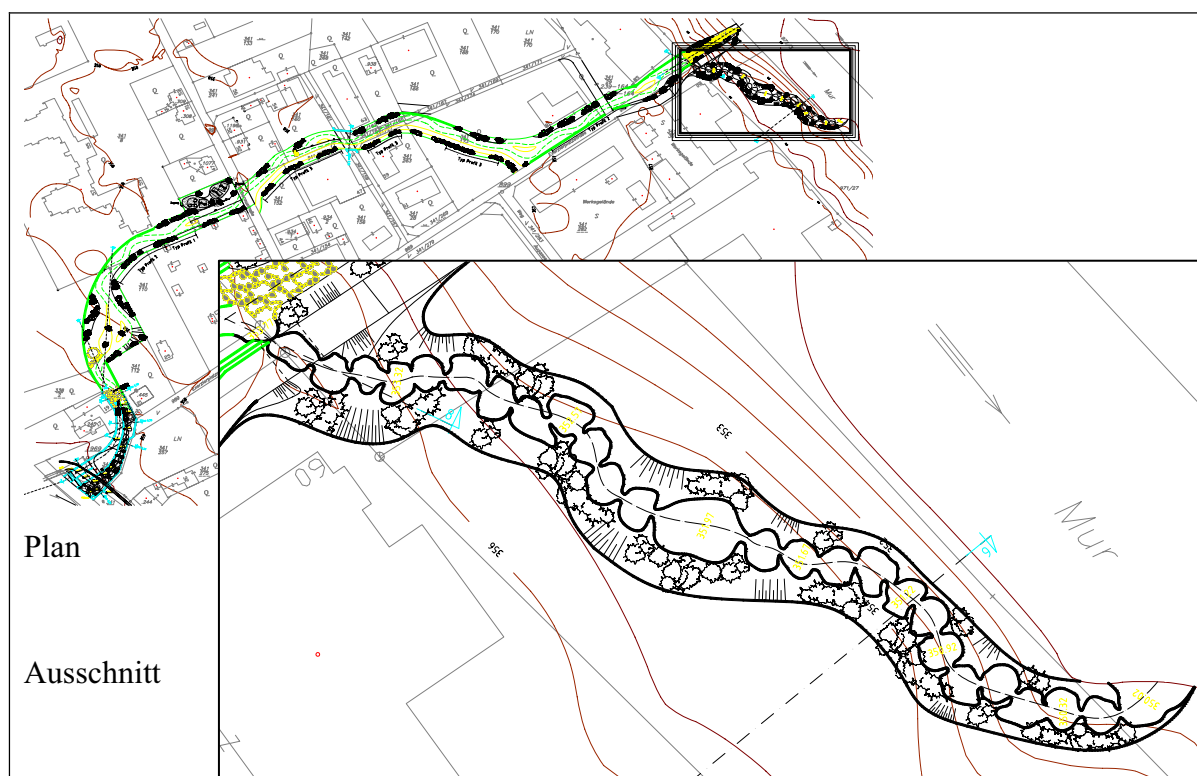
Abbildung 4.27 Fischwanderhilfe – Einmündung in die Mur
